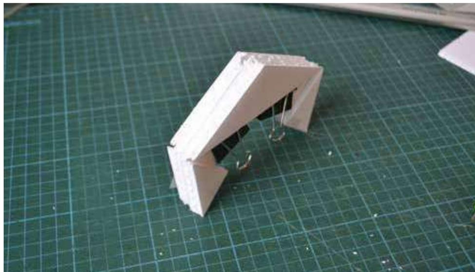
**Abb.121:** Model des Faltwerks, aufgeklappt und eingeklappt
