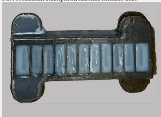
Abb.59: Foto, Druckdatei von *Soft Robotic Toolkit* [15], Material Ecoflex 00-30 und PLA Prusament, Smartphone, Karoline Meixner, 2021
