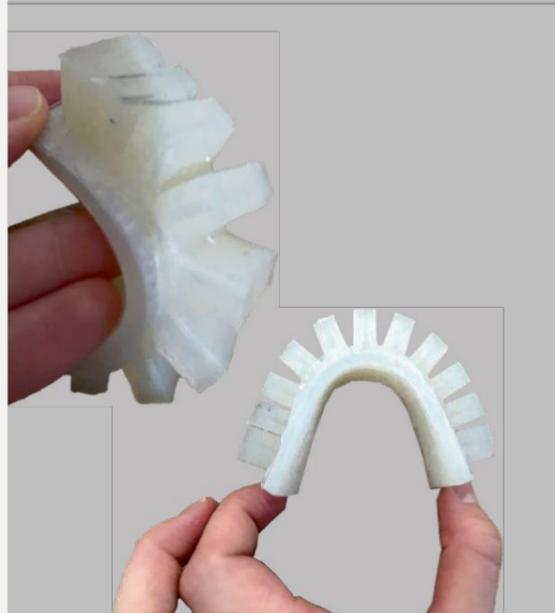
Abb.61: Fotos, Silikonform von *Soft Robotic Toolkit* [15], Material Ecoflex 00-30, Smartphone, Karoline Meixner, 2021
