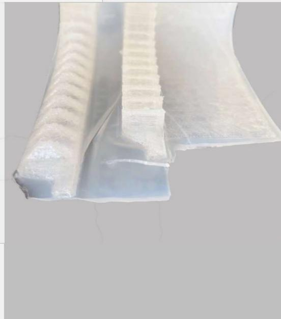
Es besteht die Möglichkeit TPU mittels Silikon zu verbinden. Somit wäre es möglich, die einzelnen Finger-Elemente zu einer Fläche miteinander zu verbinden.
