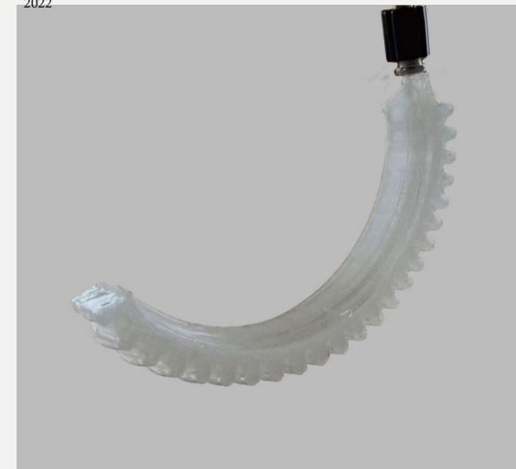
Abb.78: Foto 3D gedrucktes Modell, Nachbau kinematischer Finger von *High-Force Soft Printable Pneumatics for Soft Robotic Applications* [16], mit Luftzufuhr und Silikon-schicht, Hintergrund bearbeitet in Adobe Photoshop (Adobe Inc., USA), Smartphone, ,Karoline Meixner, 2022
