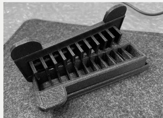
Abb.68: Foto, Druckdatei von *Sofi Robotic Toolkit*<sup>[15]</sup>, Material PLA Prusament, Smartphone ,Karoline Meixner, 2021
