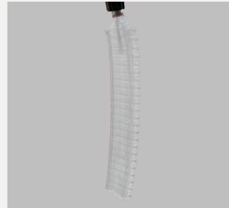
Abb.77: Foto 3D gedrucktes Modell, Nachbau kinematischer Finger von *High-Force Soft Printable Pneumatics for Soft Robotic Applications* [16], ohne Luftzufuhr, Hintergrund bearbeitet in Adobe Photoshop (Adobe Inc., USA), Smartphone, ,Karoline Meixner, 2022
