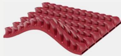
Abb.193: kinematische Finger verformt, Blender (Blender Foundation, Niederlande), Karoline Meixner 2022
