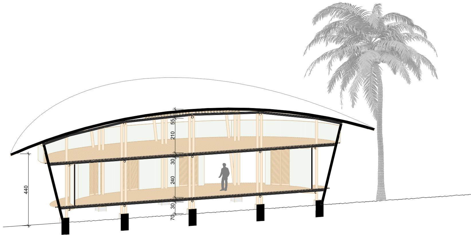
Abb 71 Längsschnitt durch Wohnpavillon
