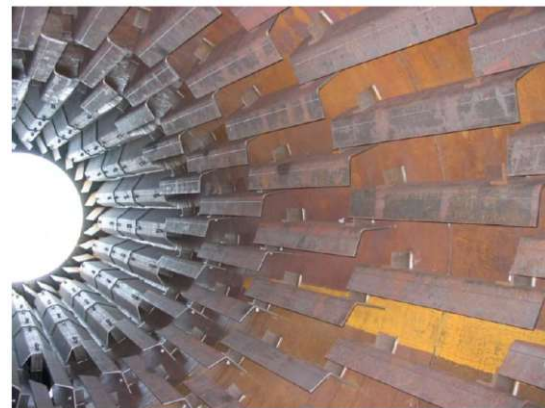
Abb. 2.12: Innenansicht einer Trockentrommel [21]
