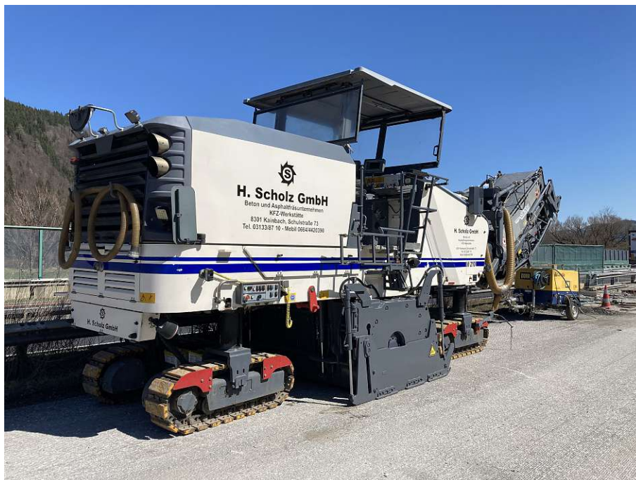
Abb. A.1: Fräse mit 2,00 m Fräsbreite
