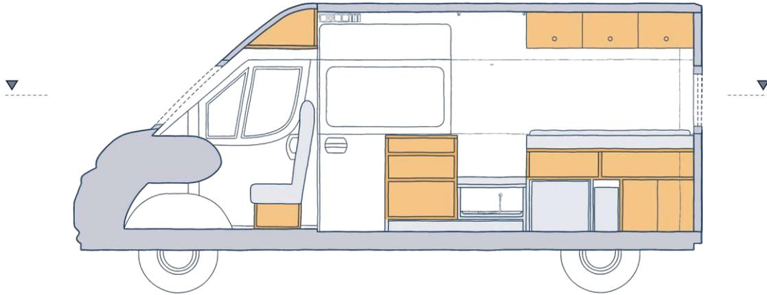
Abbildung 101: Campervan für eine Person - Verstaussysteme - Schnitt B (Maßstab 1:50)
