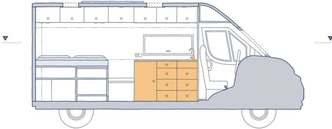
Abbildung 85: Campervan für eine Person - Küche - Schnitt A (Maßstab 1:50)
