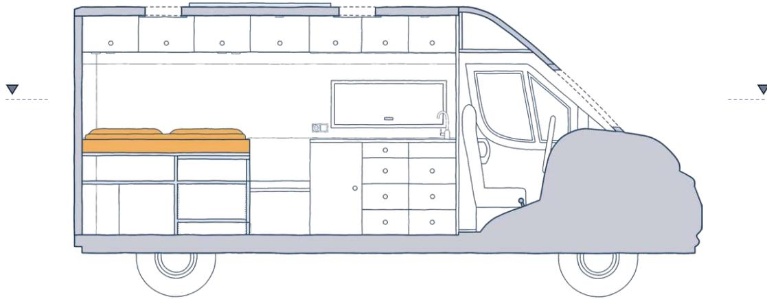
Abbildung 88: Campervan für eine Person - Bett - Schnitt A (Maßstab 1:50)
