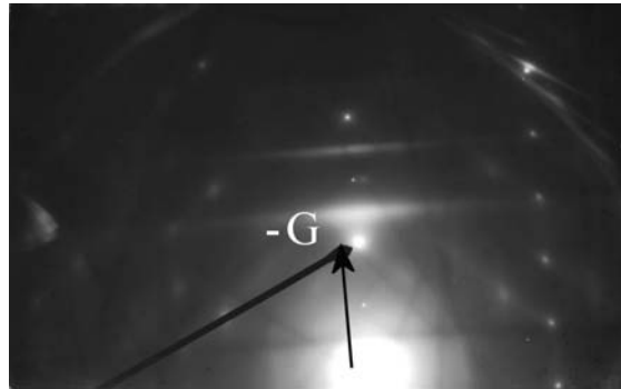
c) DF Beugungsbild unter Anregung von \bar{g}/2 \bar{g} , wobei -\bar{g}=(00-4) -Reflex ist, bei \bar{s}=0 in der Nähe des [110] -Pols,
