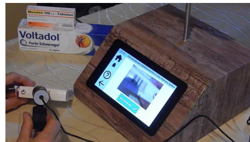
(b) Ein weitere Testperson scannt den Strichcode eines Medikamentes, um dieses hinzuzufügen.
