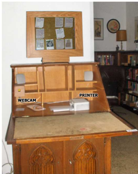
Abb. 3.7: Die digitale Pinnwand wurde zusammen mit der Webcam und einem Drucker in einen Sekretär integriert. [225]
