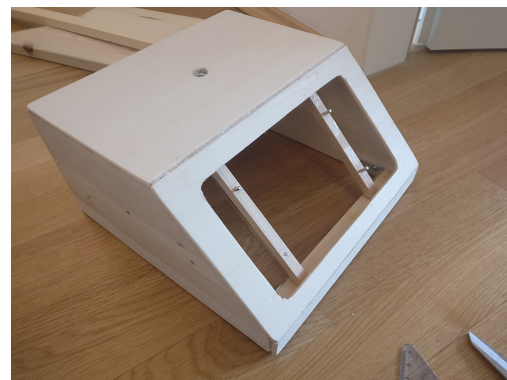
(b) Die fertige Konstruktion des Unterbaus der Lampe, bevor die Designfolie angebracht wurde.
