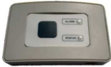
Abb. 2.13: Der Sturzsensoren, der von den BewohnerInnen an der Hüfte getragen wird. [172]
