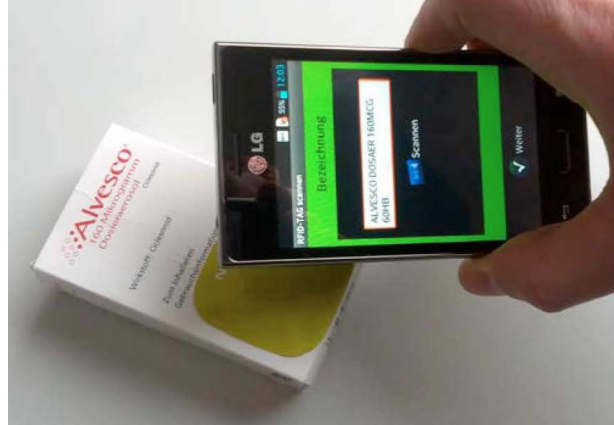
Abb. 3.2: Scannen eines Medikamentes mittels des angebrachten RFID-Tags. [195]
