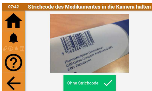
Abb. 4.46: Mit der angeschlossenen Kamera kann der Strichcode zur Erkennung des Medikamentes eingescannt werden.
