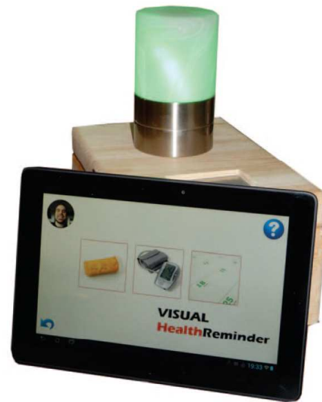
Abb. 3.8: Der Visual Health Reminder besteht aus zwei Komponenten: Medikationslampe inkl. Basisstation und einer Tablet-Applikation für die Bedienung. [26]
