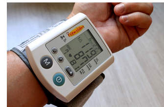
(c) Automatisches Blutdruckmessgerät am Handgelenk unter Verwendung von Tonometrie. [90]
