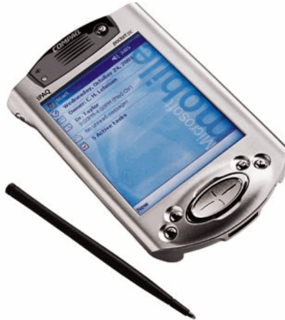
Abbildung 3.4: „iPAQ 3835“ Taschencomputer der Fa. Compaq [29]. Der 8x13cm große Taschencomputer verfügt über einen 206MHz Intel StrongARM Prozessor, 32Mbyte Flash-Speicher und 64Mbyte SDRAM.
