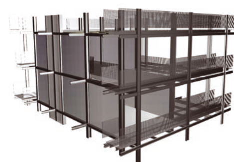
DACHAUFBAU OG - STAHLBLECH-WÄRMEDÄMMUNG- TRAPEZBLECH - BETON
