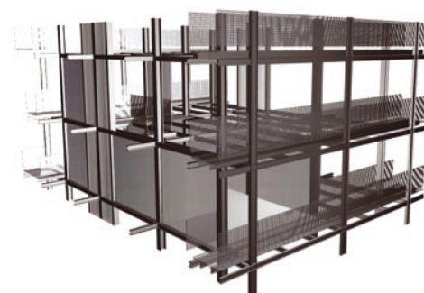
FUSSBODENAUFBAU OG - TRAPEZBLECH-BETON STIEGE SEITENWÄNDE OG - SANDWICHELEMENTE
