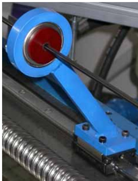
Abbildung 58: Lünette mit dem geführten Bohrer
