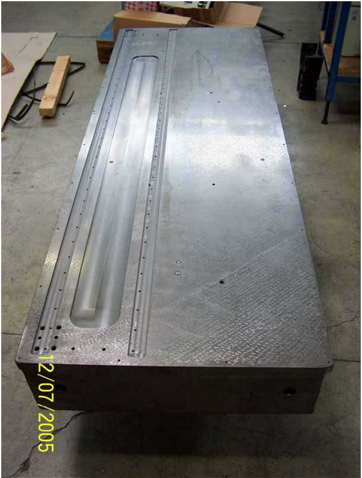
Werkzeuggestisch mit gefrästen Nuten
