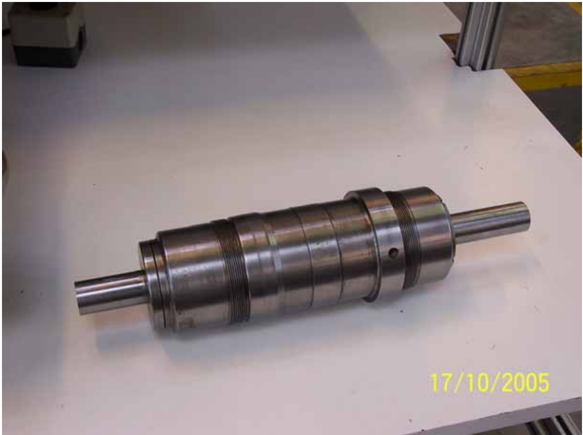
Spindel mit der neuen Welle
