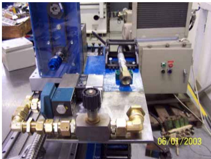
Montage der Hydraulikleitung
