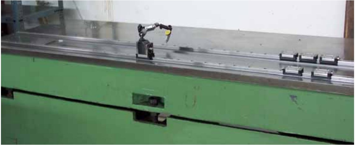
Abbildung 57: Vermessung der montierten Führungen
