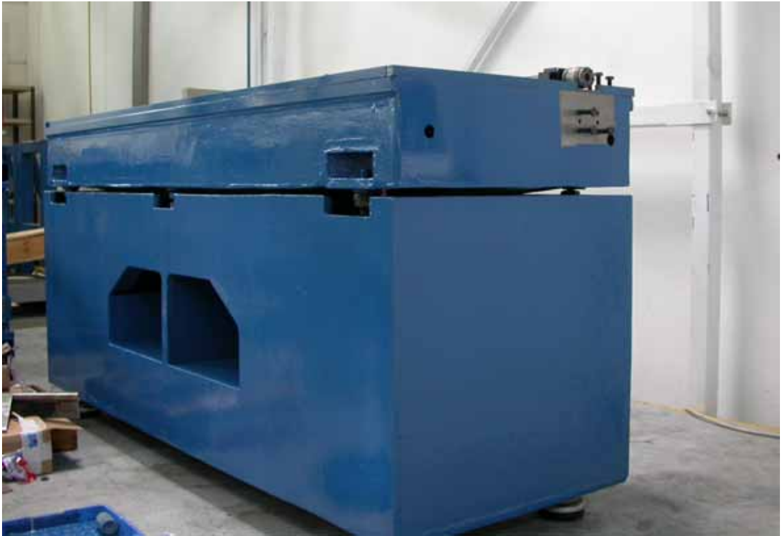
Werkzeuggestell frisch lackiert und an dem Fundament angebracht
