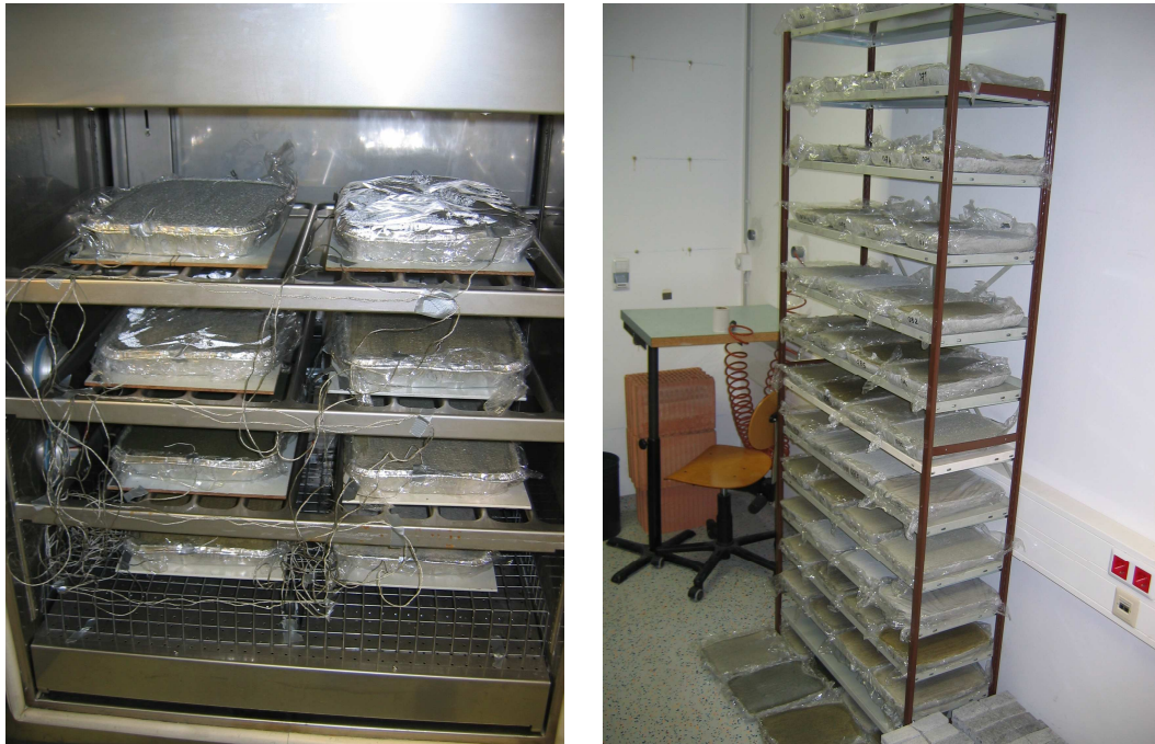
Abbildung 11: Lagerung der Proben im Klimaschrank (links) und bei Standardbedingungen (rechts)
