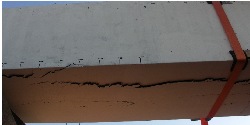
Abbildung 10.10: VK2 – Längsriss nach Komplettversagen
