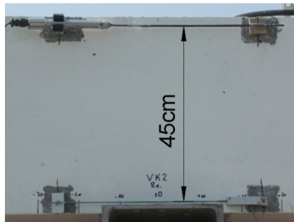
Abbildung 9.25: Abstand der Messgeräte zur Dehnungs- und Stauchungsermittlung
