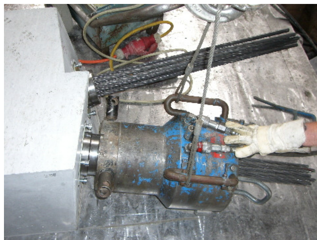
Abbildung 4.5: Vorspannen der Versuchskörper
