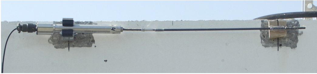
Abbildung 7.2: Induktiver Wegaufnehmer und Positionierung
