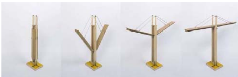
Abb. 22 Abfolge des Klappvorganges mit dem Modell – Zugstrebe (PEZ, 2007)
