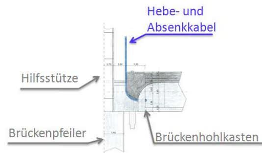
Abb. 122 Lage Brückenträger auf Pfeilerkopf – D. m. H.
