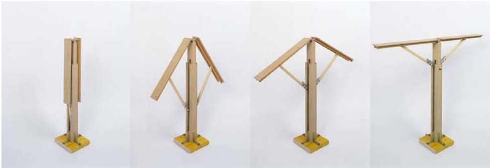
Abb. 23 Abfolge des Klappvorganges mit dem Modell – Druckstrebe (PEZ, 2007)
