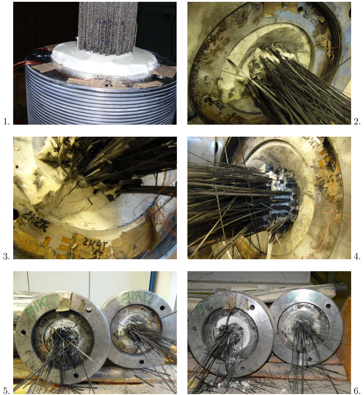
Abbildung 6.51: 1. bis 4. lastnahe Stirnseite Verankerung 84 KI 1: 1. vor Versuchsbeginn; 2. bis 4. nach Versuchsende; 5. und 6. Verankerungen 84 KI 1 (linke Verankerung) und 84 KI 2 (rechte Verankerung) nach dem Versuch; 5. vor und 6. nach dem Entfernen eventuell vorhandener loser Vergussteile
