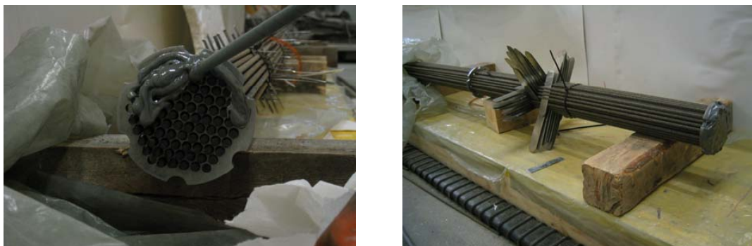
Abbildung 5.12: Links: Verkleben des CFK-Drahtbündels mit einem 2-Komponenten-Epoxidharz; rechts: Verklebtes Ende mit Steckblechen und zweiter Zentrierscheibe beim Aushärten
