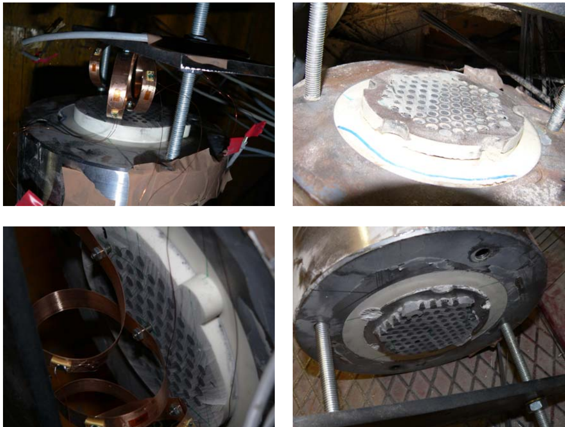
Abbildung 6.49: Lastferne Verankerungsseite: 84 KI 1 vor (oben links) und nach (oben rechts) dem Versuch; 84 KI 2 vor (unten links) und nach (unten rechts) dem Versuch
