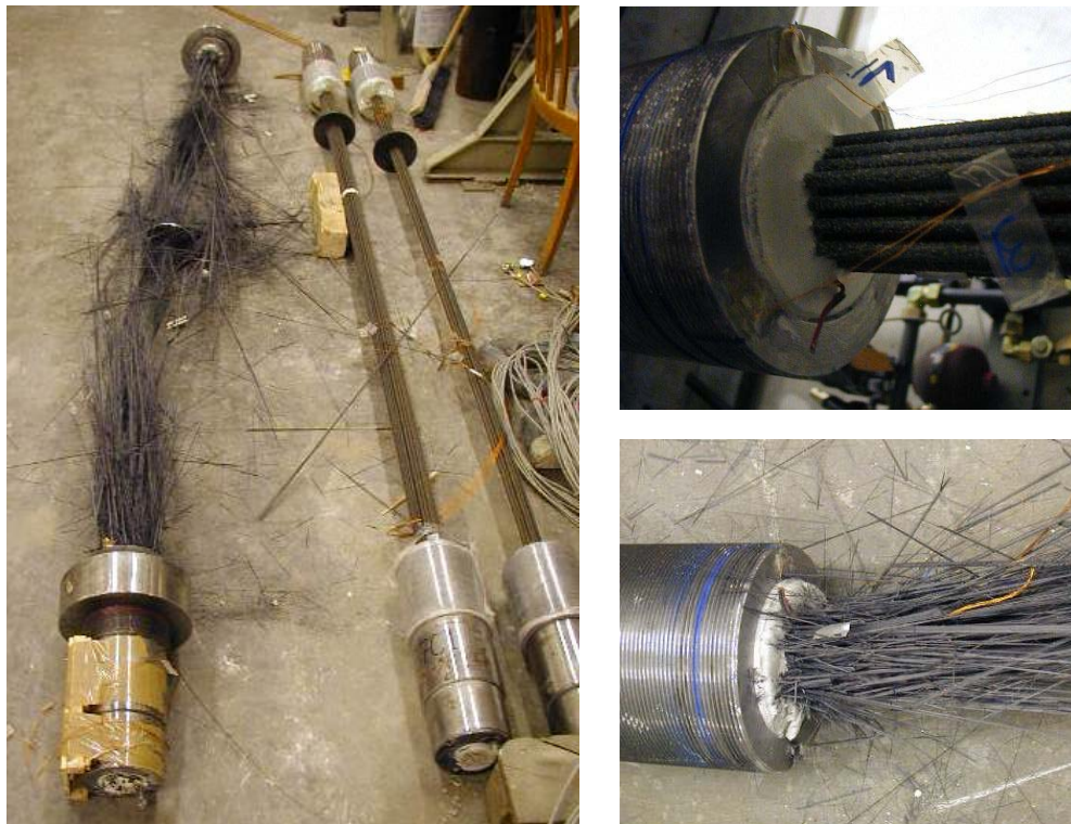
Abbildung 6.15: Links: CFK-Testspannglieder vor und nach dem Zugversuch; rechts: lastnahes Verankerungsende vor (oben) und nach (unten) dem Zugversuch
