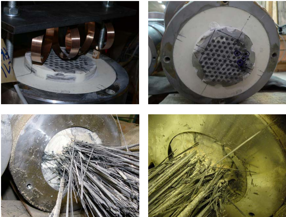
Abbildung 6.62: Verankerung 84 ZI 1: lastferne Seite, vor (oben links) und nach (oben rechts) dem Versuch; lastnahe Seite nach dem Versuch (unten)
