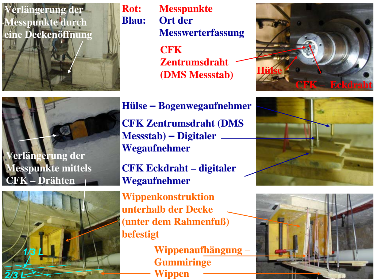
Abbildung 5.33: Wippenkonstruktion zur Messung der Einzüge
