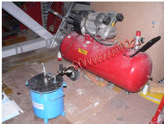
Abbildung 4.17: Der für das Entgasen und Einbringen der Vergussmasse notwendige Drucktopf; sowie der für das Aufbringen des Verpressdruckes von 2 - 2,5 bar erforderliche Kompressor.
