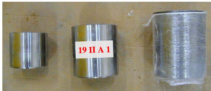
Abbildung 5.7: Gereinigter und teflonbeschichteter dreiteiliger Verankerungskörper vom Typ 19 II
