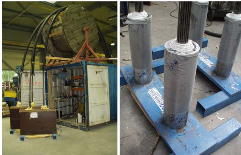
Abbildung 8.9: Links: Umlenkbock; rechts: ausgehärtete Vergusskörper
