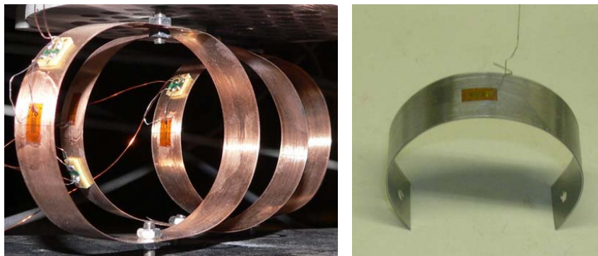
Abbildung 5.6: Links: Bogenwegaufnehmer – Ringförmig; rechts: Bogenwegaufnehmer – Halbkreisförmig vor der Fertigstellung
