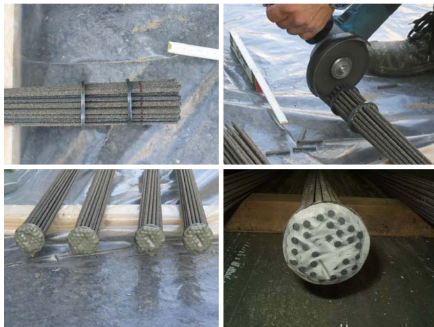
Abbildung 8.5: Ablängen der CFK-Drähte auf die errechnete Endlänge und Endfixierung des hexagonalen Zugelements
