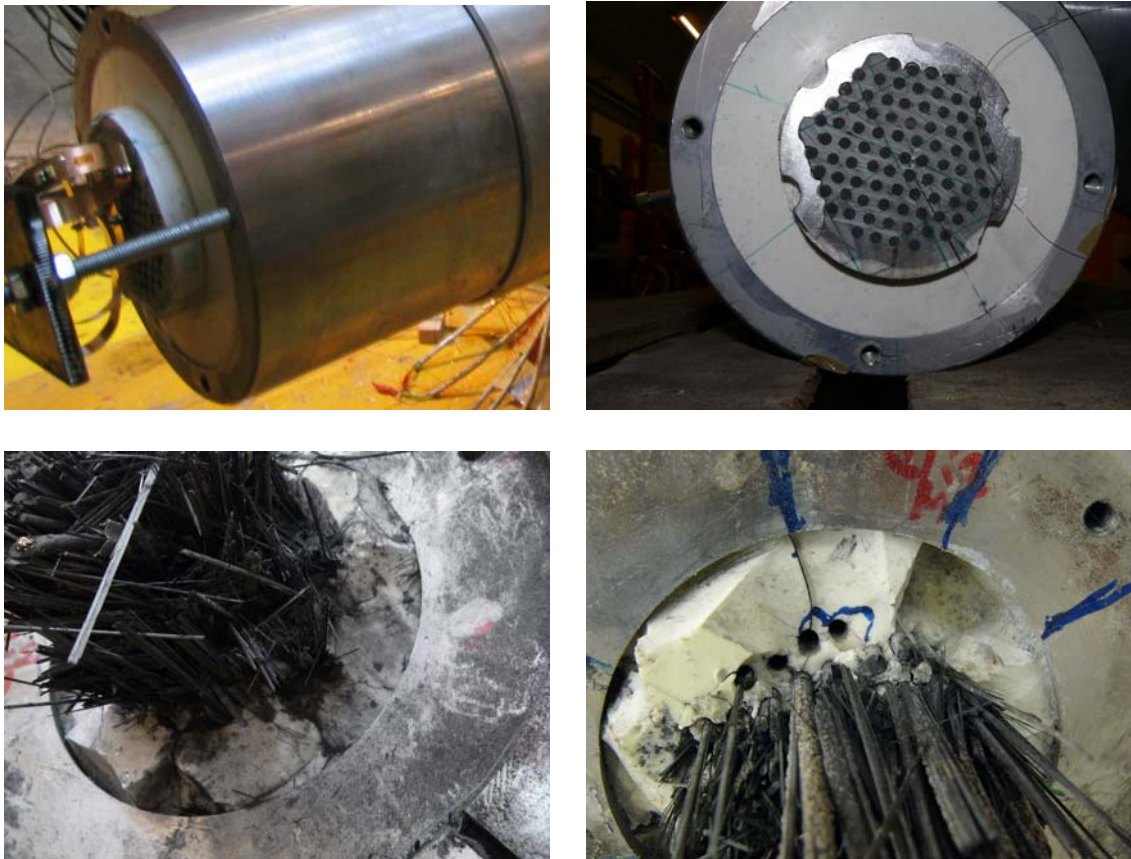
Abbildung 6.63: Verankerung 84 ZI 2: lastferne Seite, vor (oben links) und nach (oben rechts) dem Versuch; lastnahe Seite nach dem Versuch (unten)
