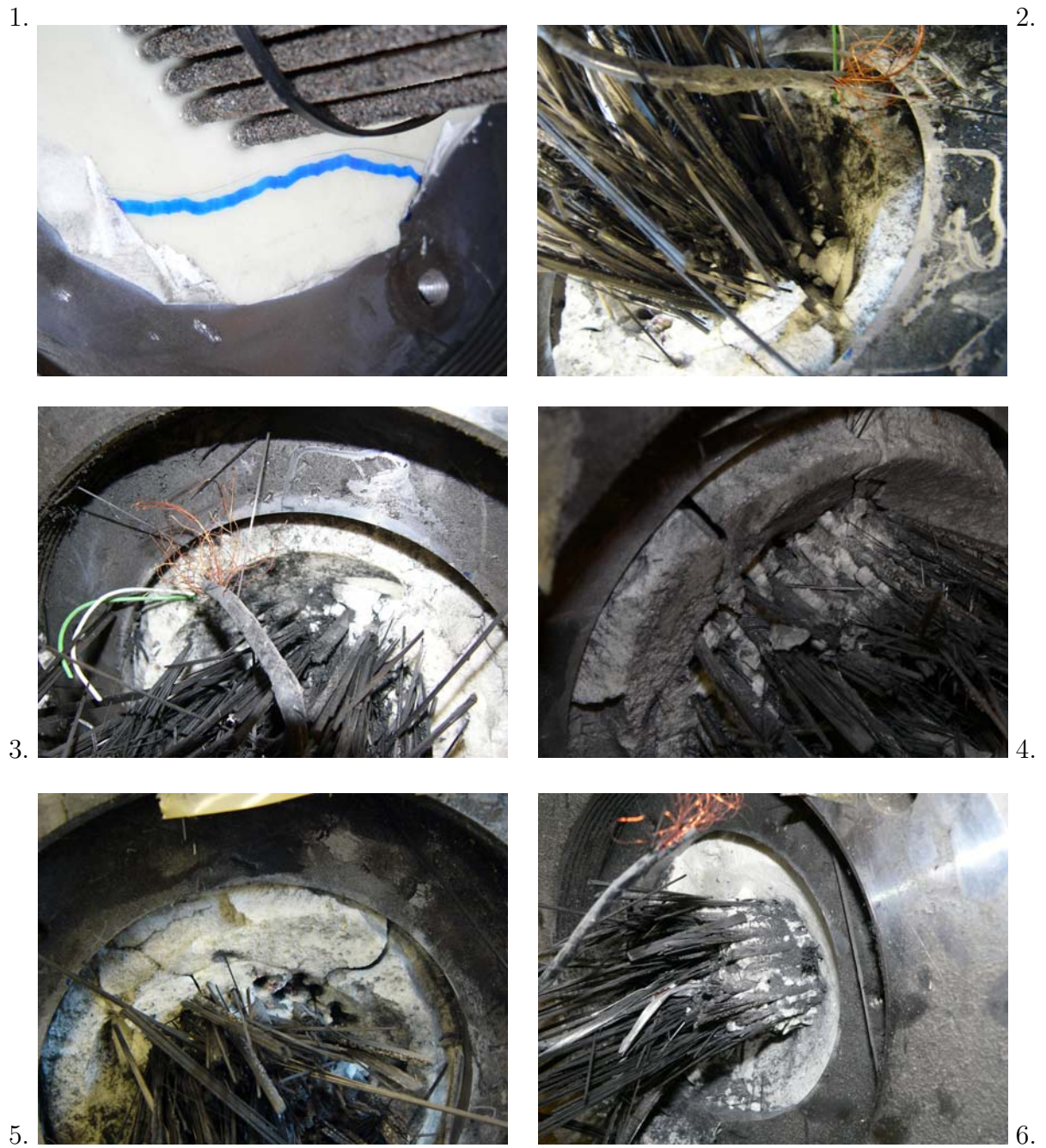
Abbildung 6.50: Lastnahe Stirnseite Verankerung 84 KI 1: 1. vor Versuchsbeginn: Riss im Epoxidharzüberguss - entstanden beim Entfernen vom übergelaufenen Epoxidharz; 2. bis 6. nach Versuchsende ; 5. vor und 6. nach dem Entfernen der losen Vergussteile
