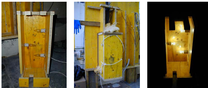
Abbildung 4.18: Tempervorrichtung für die 19- und 37-Drahtverankerungen; links: offener Temperkasten; mitte: Tempervorgang; rechts: offener Temperkasten - Heizphase
