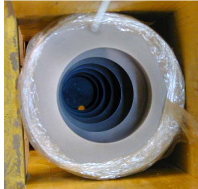
Abbildung 5.9: Blick in die zusammengesetzte und teflonbeschichtete Vergussverankerung
