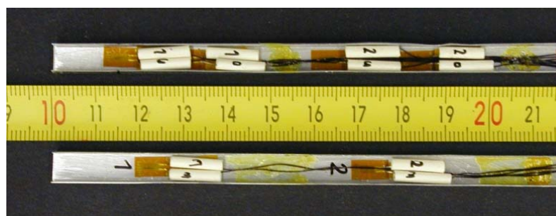
Abbildung 5.3: Ausschnitt (Konus 1 und 2) des DMS-Messstabes für den Ankerkörper 19 I A 1 (insgesamt 18 DMS)
