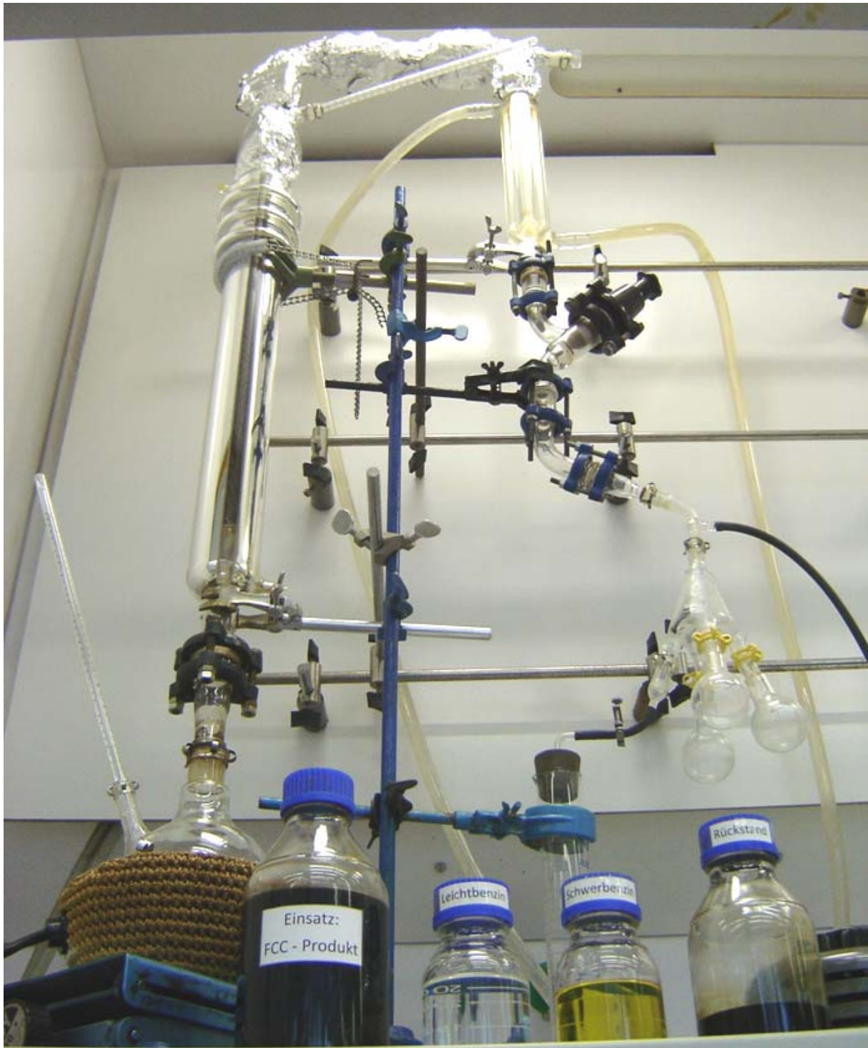
Abb. 5-2: Destillationsapparatur zur Analyse der wasserfreien flüssigen Probe
