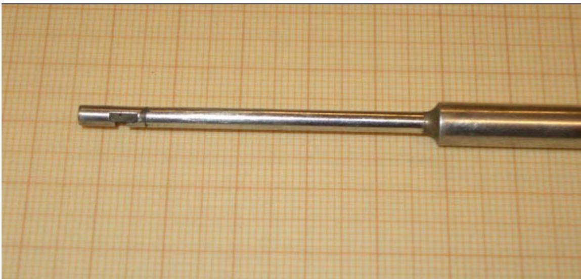
**Abb. 2.4: Foto der Fünflochsonde DA-125-18-F-16-C (Sondenkopf, Seitenansicht)**
