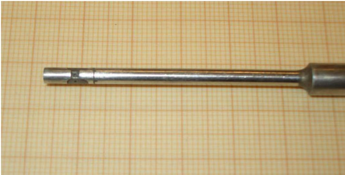
**Abb. 2.3: Foto der Fünflochsonde DA-125-18-F-16-C (Sondenkopf, Frontansicht)**
