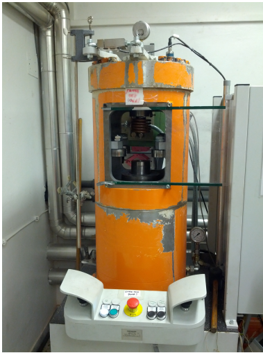
Abbildung 3.4: Die Anlage auf der Universität Wien, die für die Hochdruckverformung verwendet wurde
