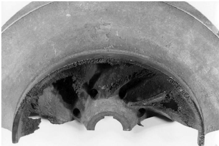
Abbildung 2.6: Ein durch Kavitationserosion zerstörtes Laufrad einer Radialpumpe [13]
