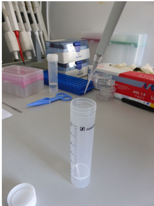
Abbildung 3.2.: Pipettieren von 2,5 \mu\text{l} in ein 10 ml Probenfläschchen.
