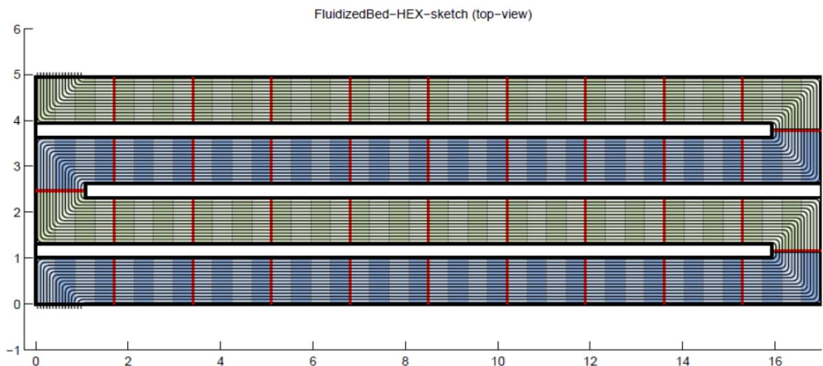
Bild 38: Draufsicht eines horizontalen Schnitts durch den Wärmetauscher [10]
