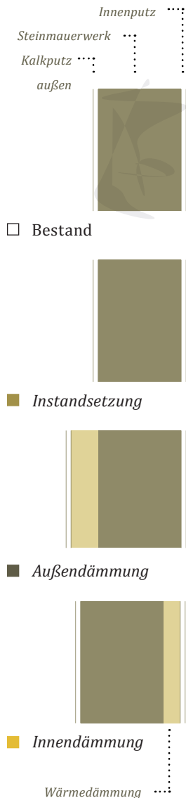
Abb. 99: Möglichkeiten der Instandsetzung massiver Steinwände
