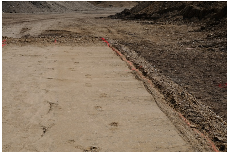
Abbildung 6-7: Unruhiger Untergrund als Grund für Fehler bei der Asymmetrierauswertung
