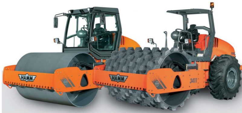
Abbildung 2-7: Glattmantelbandage (links) und Schafffußbandage (rechts) [3]
