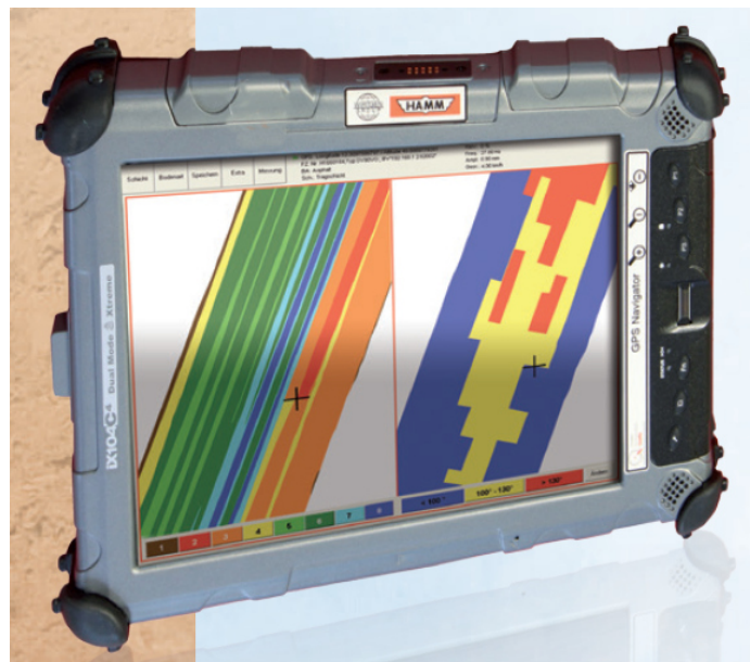
Abbildung 2-17: Illustration des Verdichtungserfolges [3]
