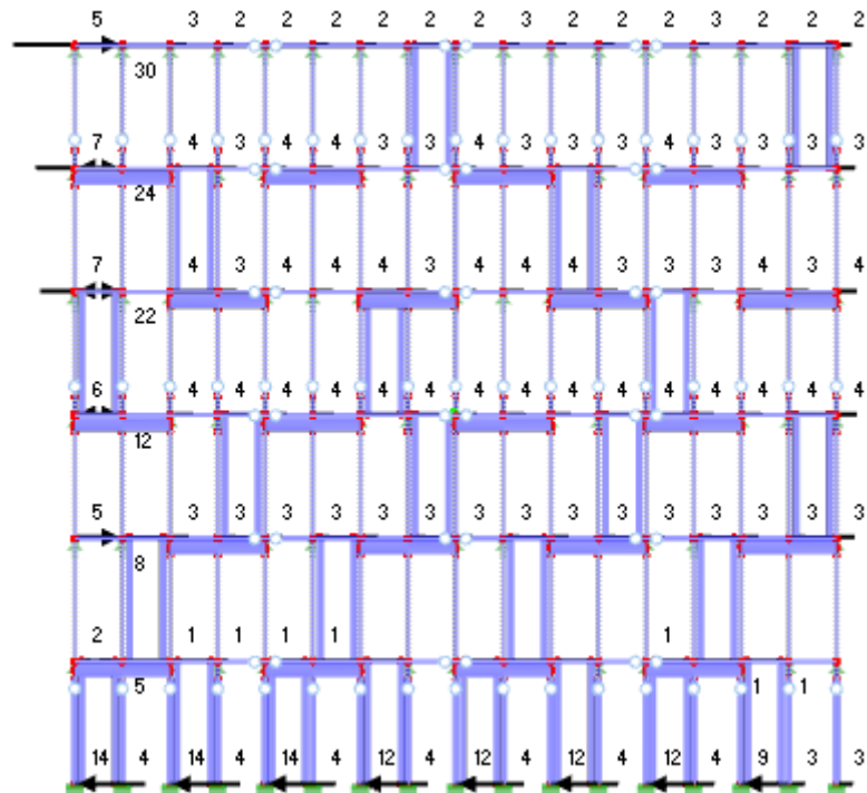
Abb. 154: Variante 1, 100 cm Auskrägung, Minimalwerte der Lagerreaktionen in X-Richtung
