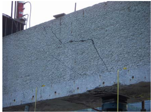
Abb. 8-20: Entstehung des Schubrisses Träger Nr.1 auf der gestuckten Trägerseite
