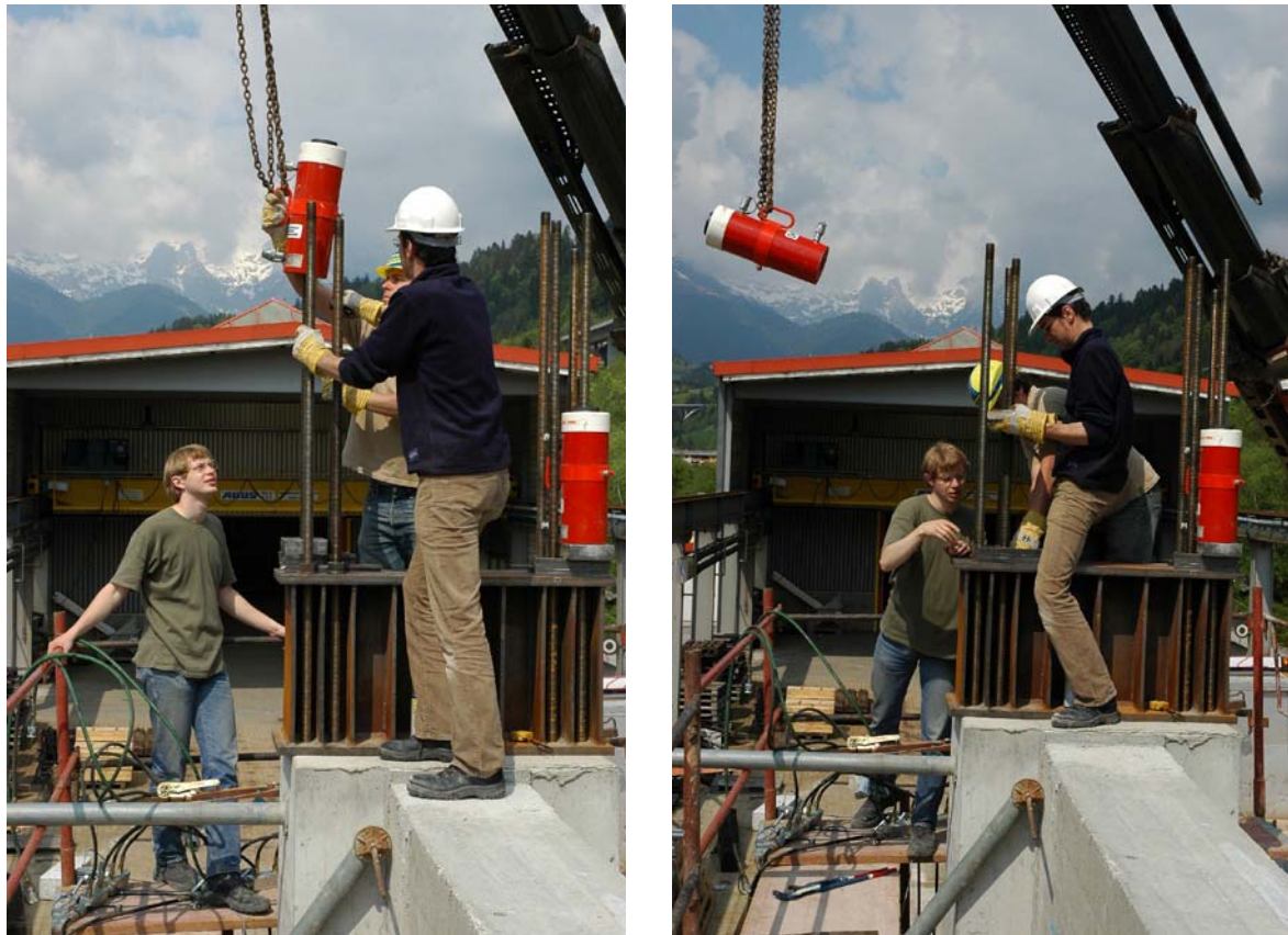
Abb. 3-2 : Umsetzarbeiten beim Vorspannen der Auflager
