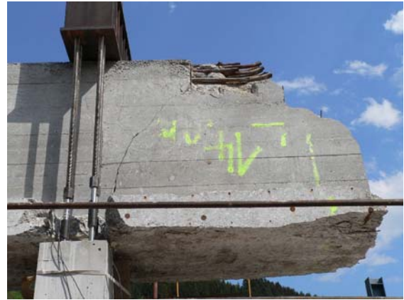
Abb. 8-13: Bestandsaufnahme der Risse vor Versuchsbeginn
