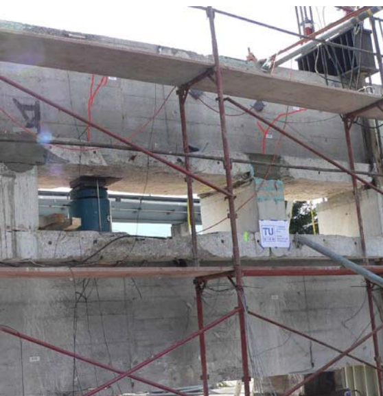
Abb. 8-15: Darstellung Rissbild Laststufe 6 und Höchstlast
