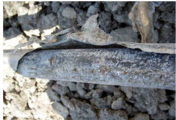
Abb. 8-27: Guter Zustand der Spannähle
