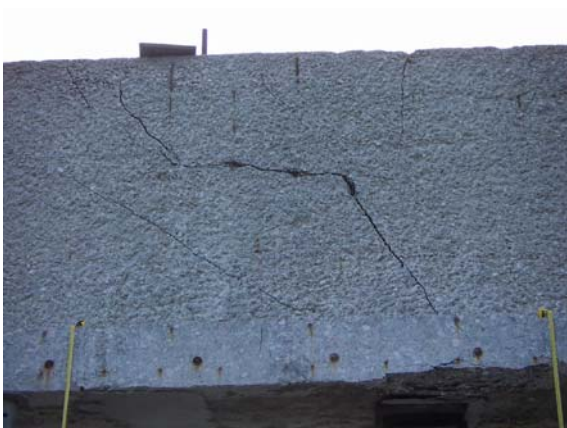
Abb. 8-22: Rissverlauf bei Höchstlast Träger Nr.1 und Rissdetail Träger Nr.2
