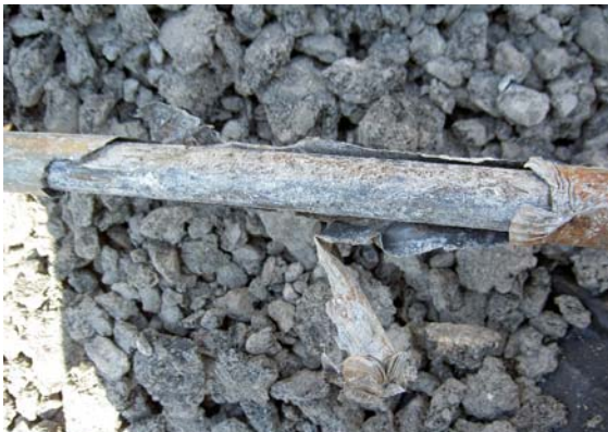
Abb. 8-27: Guter Zustand der Spannähle
