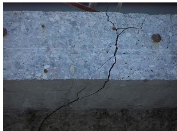
Abb. 8-22: Rissverlauf bei Höchstlast Träger Nr.1 und Rissdetail Träger Nr.2
