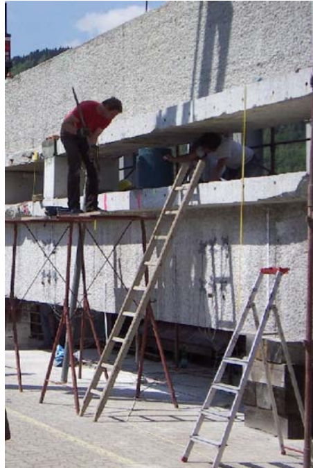
Abb. 3-14: Einbau Presse Belastungsversuch Nr. 3
