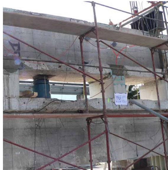
Abb. 8-14: Darstellung der Risse V1 Laststufe 0 und Laststufe 4
