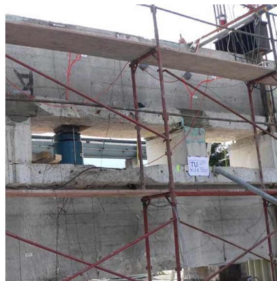
Abb. 8-15: Darstellung Rissbild Laststufe 6 und Höchstlast
