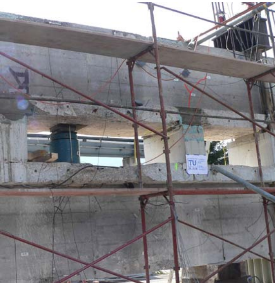
Abb. 8-14: Darstellung der Risse V1 Laststufe 0 und Laststufe 4
