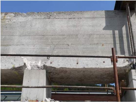
Abb. 8-13: Bestandsaufnahme der Risse vor Versuchsbeginn
