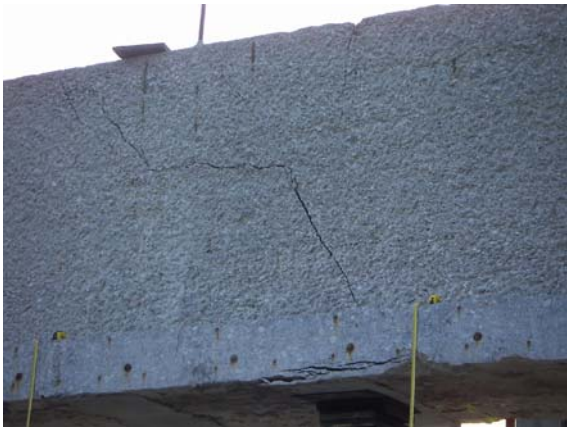
Abb. 8-20: Entstehung des Schubrisses Träger Nr.1 auf der gestuckten Trägerseite
