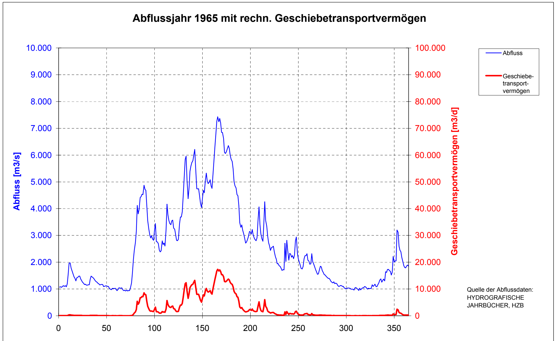
Abb. 7-6: Rechnerisches Geschiebetransportvermögen für das Abflussjahr 1965
