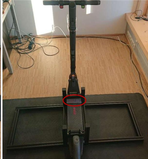
Abbildung 2: Ursprünglicher E-Scooter-Ständer mit Gummi-Elementen (rot umrandet)
