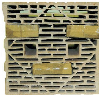
Abbildung 32: VIPs in Kammern eines Mauersteins integriert [Scu03]
