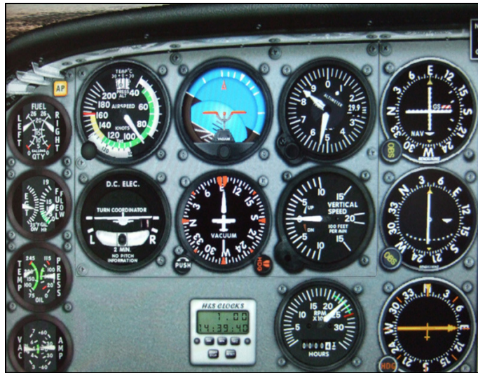
Abb 5.2.A Simulierter Ausfall des Attitude-Indicator im Flug
