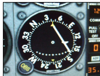
Abb 5.2.J Radial 044 des Zuni-VORs auf dem zweiten VOR-Empfänger
