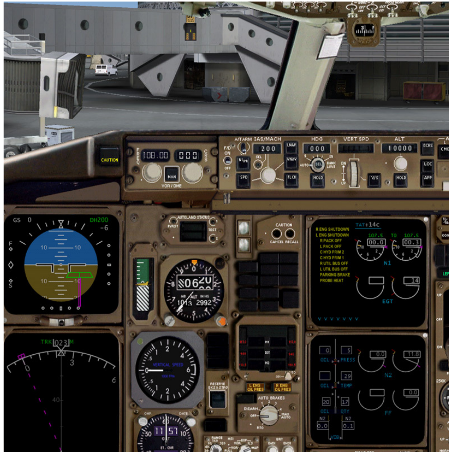
Abb 5.7.F Beobachtung der Triebwerksanzeigen beim Spool-Up
