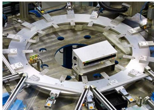
Abbildung 3.3: Rundtakttisch. (Firma Kapsch)
