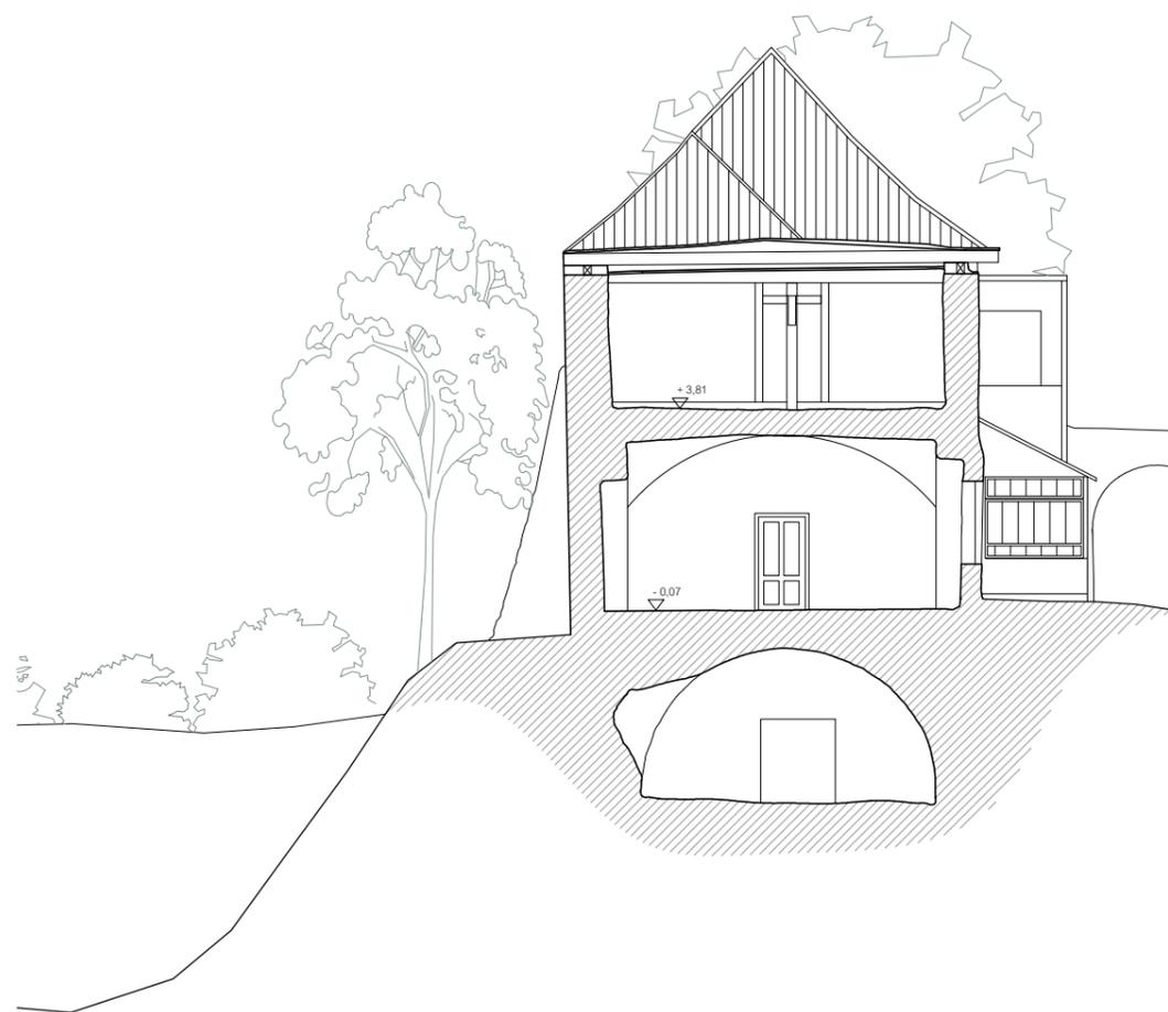
Abb. 74 Bestandsplan, Schnitt C, M 1:150
