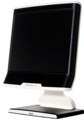
Abb. 25.: Das Erfassen der Augenbewegungen wird im Rahmen der Studie mit Hilfe des Geräts Tobii T120 Eye Tracker bewerkstelligt.
