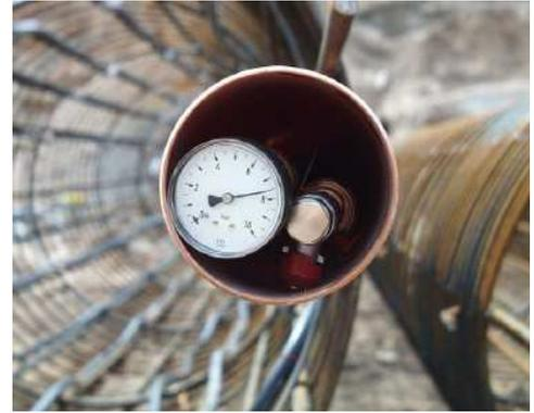
Abb. 20: Druckprüfung während der gesamten Herstellung [2]
