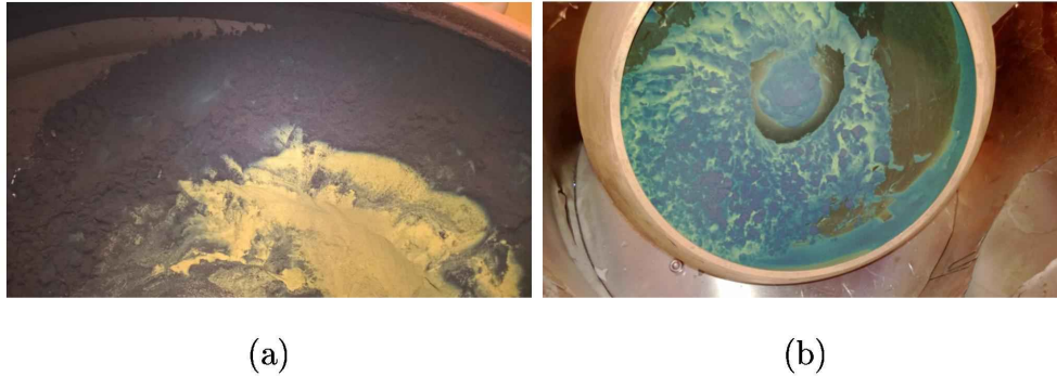
Abbildung 4.4: Fotos von zwei verschiedenen Proben von mit Kupfer beschichteten Mikrohohlglaskugeln in der Superbowl, deren Schicht sich beim direkten Öffnen nach der Beschichtung vermutlich durch Oxidation verfärbt hat.
