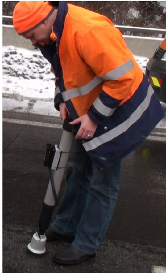
Abbildung 3.5: SOBO 20 Restsalzmessgerät
