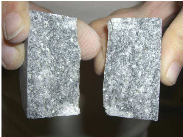
Abb. 21: Bruchflächenausbildung nach dem Brazilian-Test der bruchfrischen und im Labor beanspruchten Gesteinsproben.
