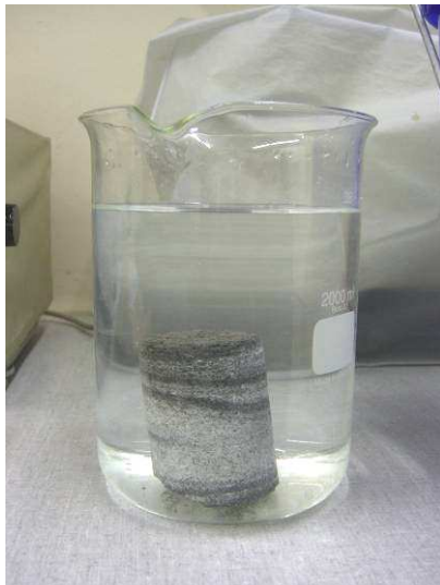
Abb. 65: Lagerung der Probe im Wasserbad zur Bestimmung der Rohdichte.
