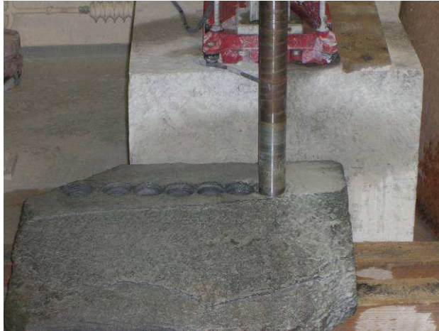
Abb. 59: Herstellung der Bohrkerne
