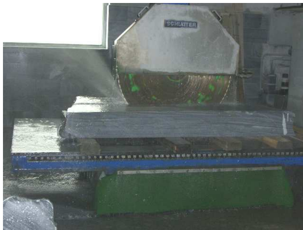
Abb. 10: Gesteinskreissäge zur Herstellung massiver Werkstücke.
