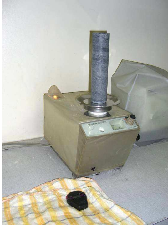
Abb. 15: Waage zur Massebestimmung mit Gesteinsprobe und Stoppuhr.
