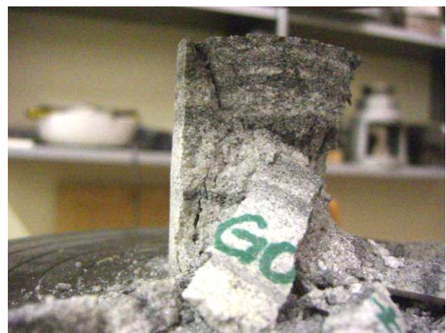
Abb. 28: Bruchbild einer maximal verwitterten Gesteinsprobe.
