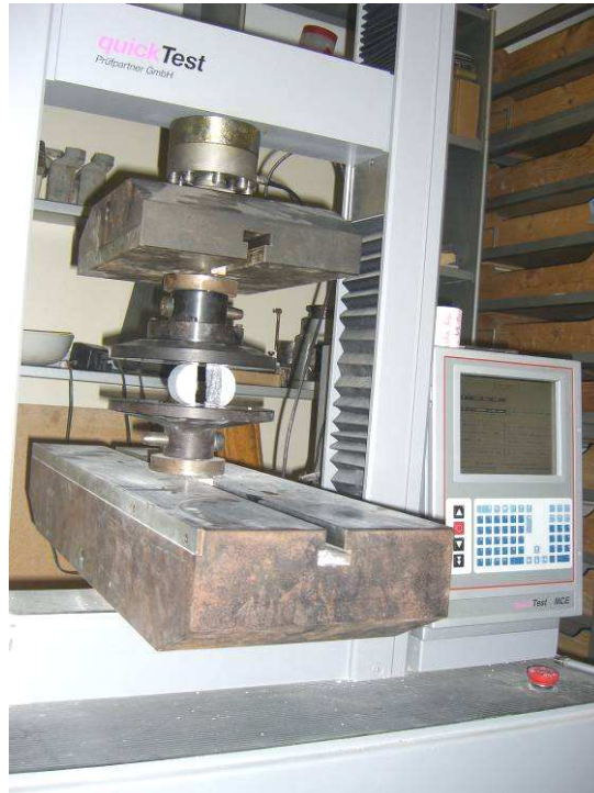
Abb. 20: Computergesteuerte Presse zur Ermittlung der Spaltzugfestigkeit mit einer eingespannten Probe.
