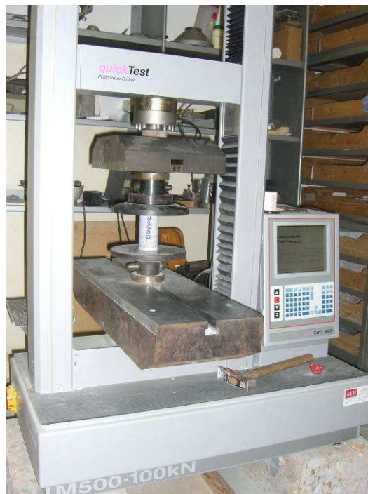
Abb. 26: Computergesteuerte Presse zur Ermittlung der einaxialen Druckfestigkeit mit einer eingespannten Probe.
