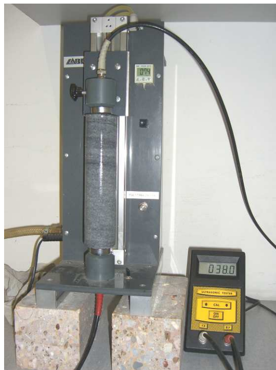
Abb. 13: Druckluftstativ mit Ultrasonic-Tester und einer eingespannten Probe.
