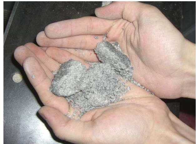
Abb. 22: Nach dem Brazilian-Test der maximal verwitterten Gesteinsproben bildete sich keine Bruchfläche aus.
