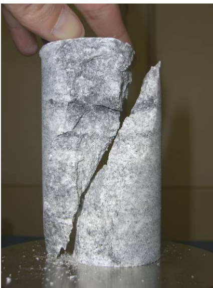
Abb. 27: Nach den einaxialen Druckversuchen stellte sich häufig dieses Bruchbild ein.
