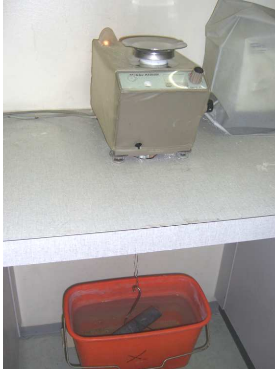
Abb. 12: Waage mit Durchhang zur Massebestimmung unter Auftrieb
