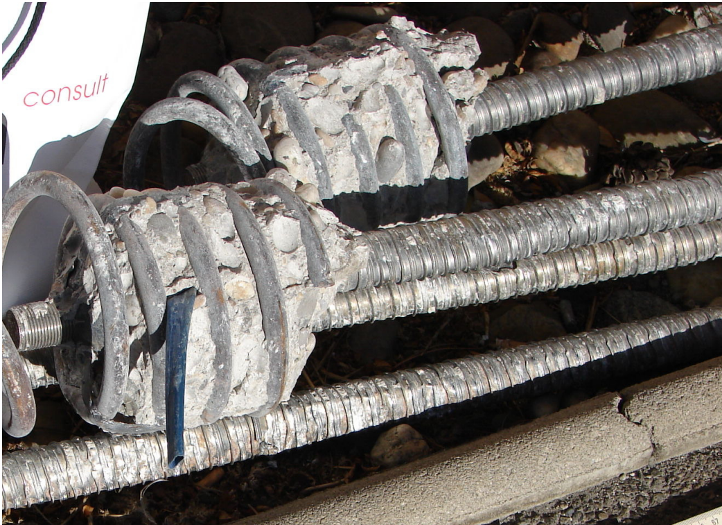
Abbildung 23: Spanngliedverankerung eines Versuchsträgers
