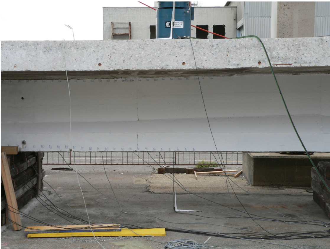
Abbildung 41: Wegaufnehmer unter dem Prüfträger
