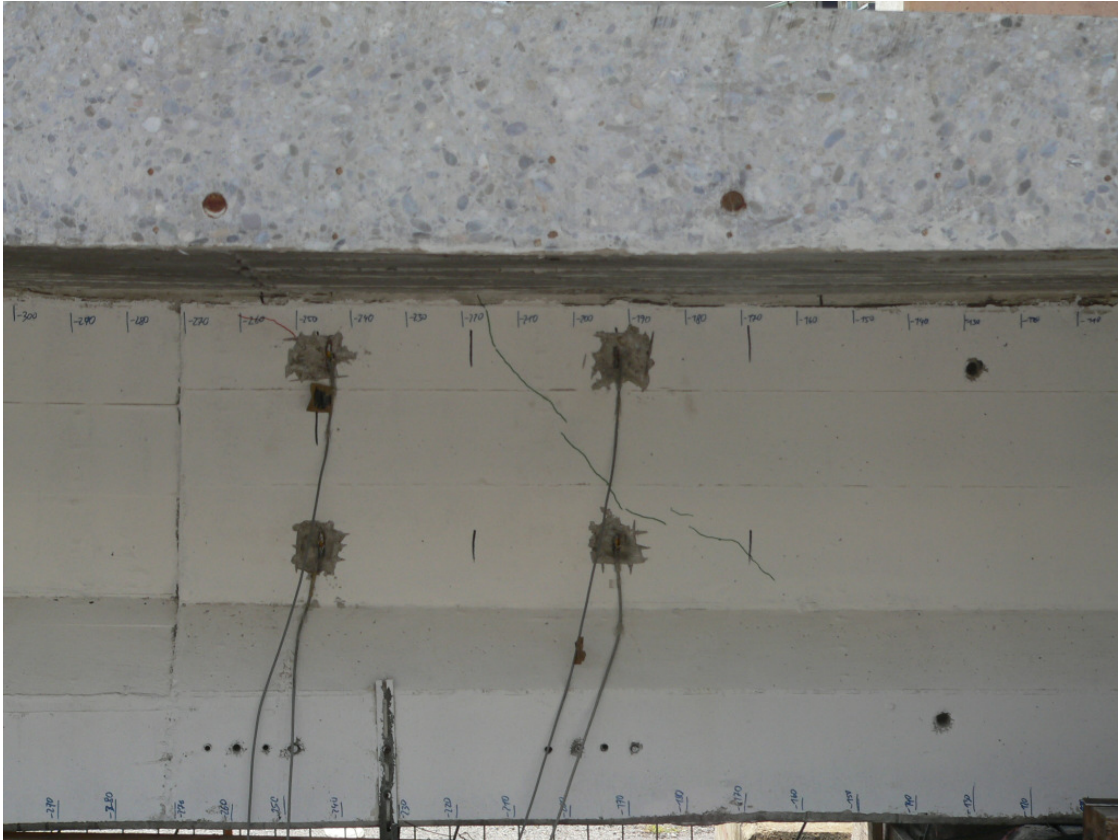
Abbildung 46: Anordnung DMS 2.1, 2.2, 2.3 und Hauptversuch
