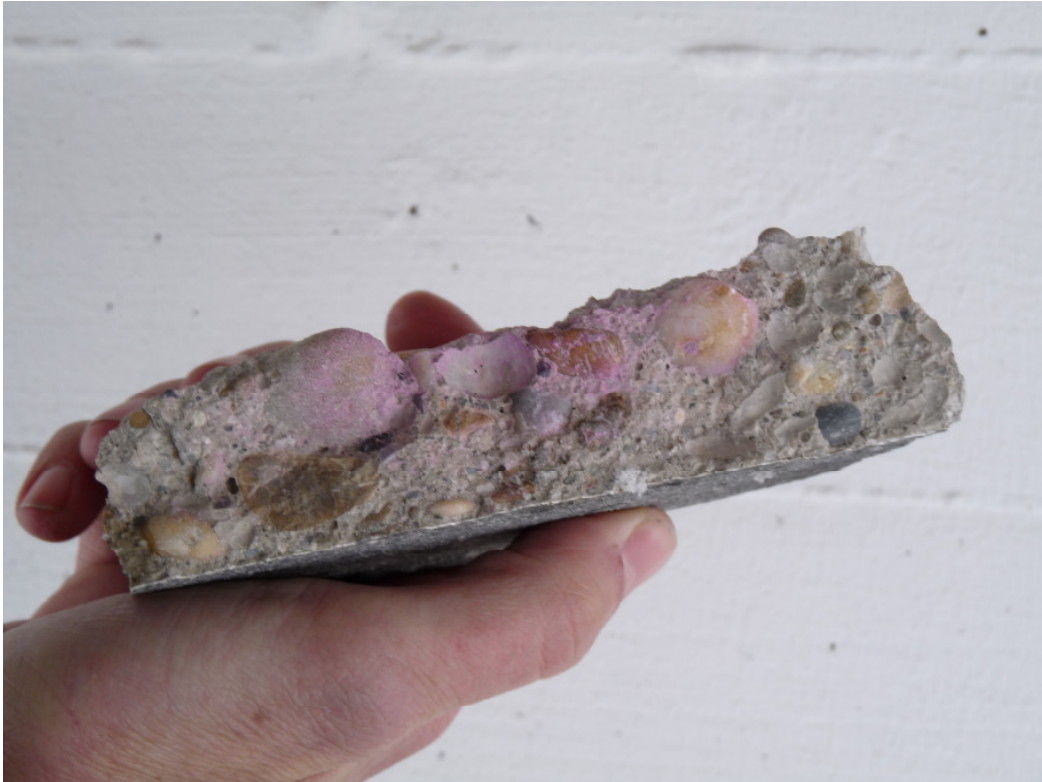
Abbildung 24: Karbonatisierung eines Versuchsträgers [10]
