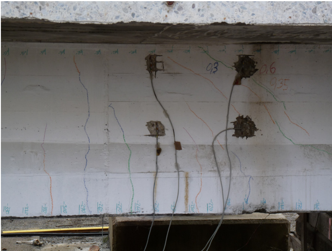
Abbildung 76: Rissbild rechte Seite – kein Riss bei DMS 5
