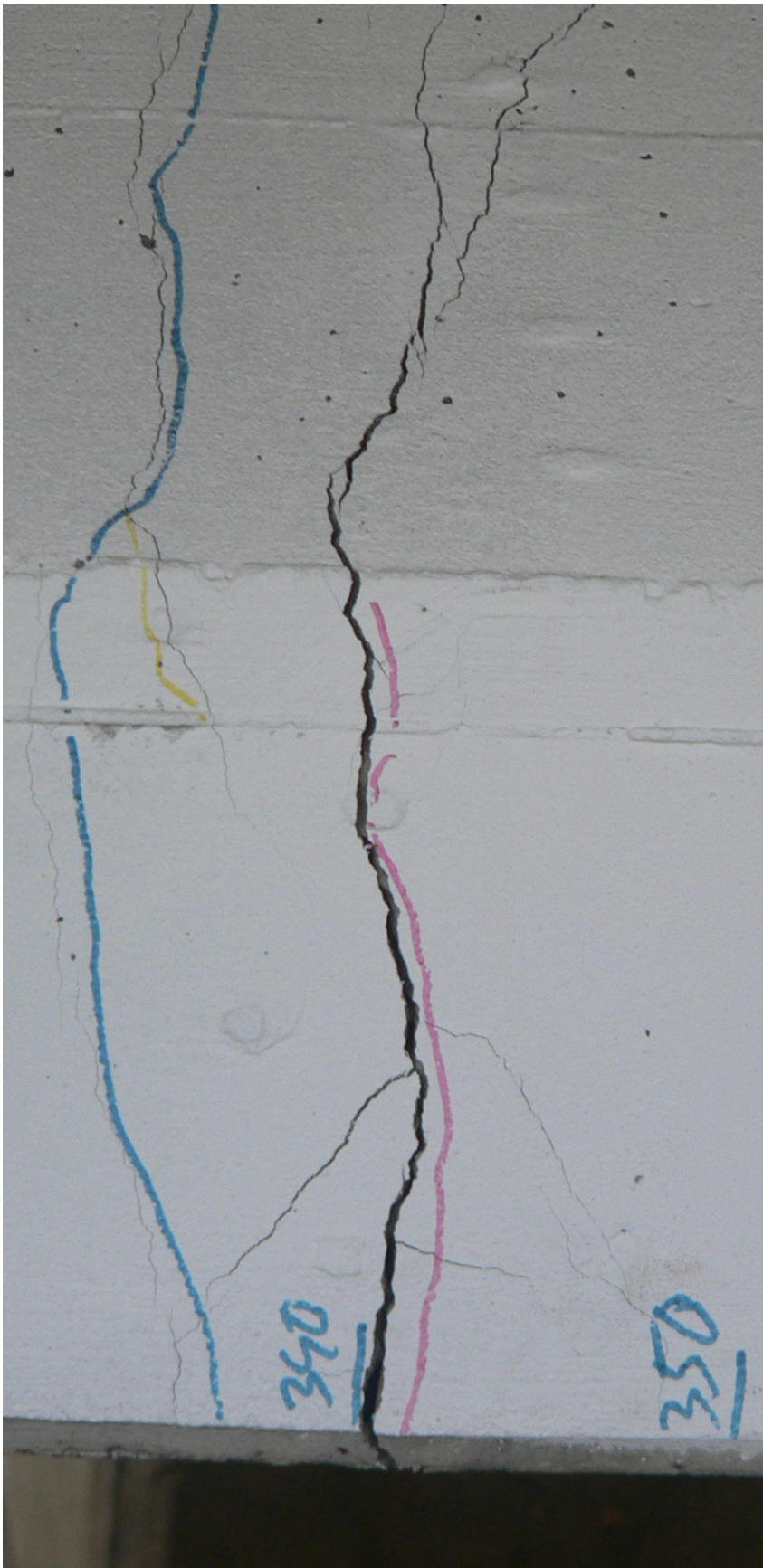
Abbildung 71: Biegeriss bei Versuchende
