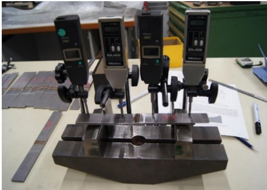
Abbildung 4-4: Messeinrichtung zur Winkelfehlermessung der Proben. Die vier Messanzeigen sollen die vertikale Verschiebung an vier Stellen messen.
