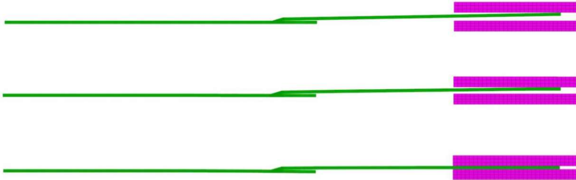
Abbildung 3-9: Simulationsmodell mit dem Winkelverzug. Die drei Schritte sollen den Simulationsvorgang der Einspannung der winkelverzogenen Probe in der Resonanzmaschine verdeutlichen.
