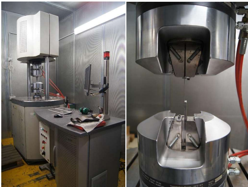
Abbildung 4-5: Power Swing MAG Resonanzprüfstand der Fa. SincoTec. Die linke Abbildung zeigt den verwendeten Prüfstand zum Dauerschwingversuch. Die rechte Abbildung zeigt eine eingespannte Testprobe zwischen den hydraulischen Spannbacken der Resonanzmaschine.
