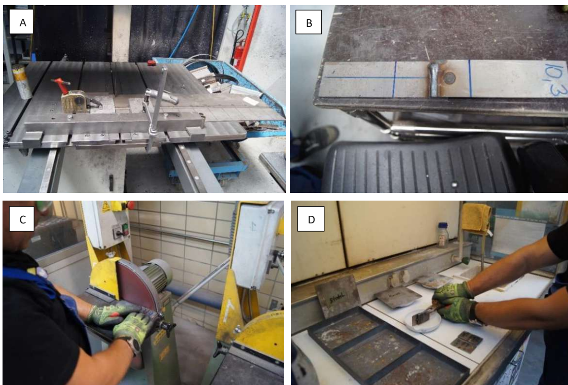
Abbildung 4-1: Verlauf der Probenpräparation für den Makroschliff. A) die Anlage zum Schneiden, B) Probenzuschnitt mit Markierung auf Enddimension, C) Schleifeinrichtung und D) die Ätzung der Schlitze.
