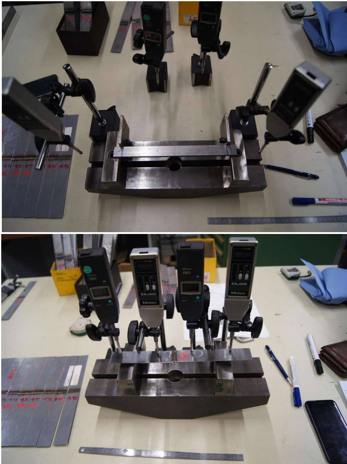
Bild C-2: Winkelfehlermessung. Oben im Bild- Einzeichnen von Abständen und unten im Bild- Einlegen der Probe und Ablesen von Messwerten aus den Messanzeigen.
