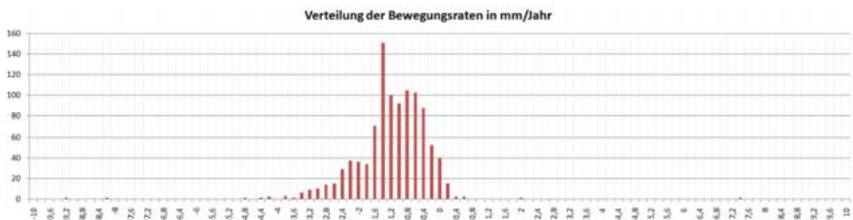
Abbildung 4.33.: Häufigkeitsverteilung der Höhenbewegungsraten mit einer Intervallgröße von 0,2 mm für einen Bereich von \pm 10 mm/Jahr (horizontale Achse). Auf der vertikalen Achse ist die Anzahl der auftretenden Werte pro Intervallklasse aufgetragen.
