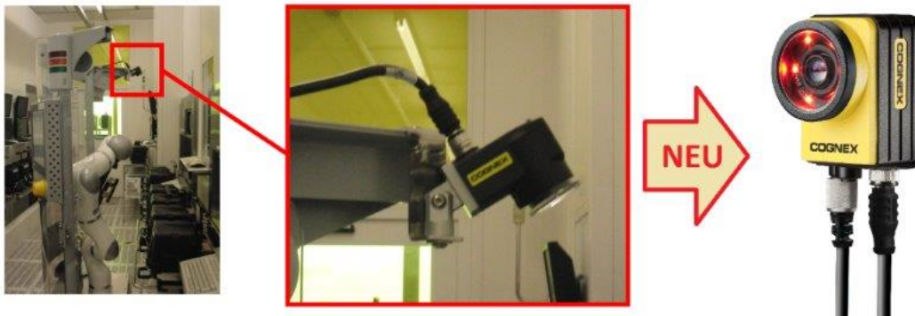
Abbildung 5.14: Am iRobotics-System montierte Checker-Kamera (links), vergrößert (Mitte) und ein Modell, welches Stati Check für ein mobiles Beladesystem übernehmen kann, sofern benötigt.
