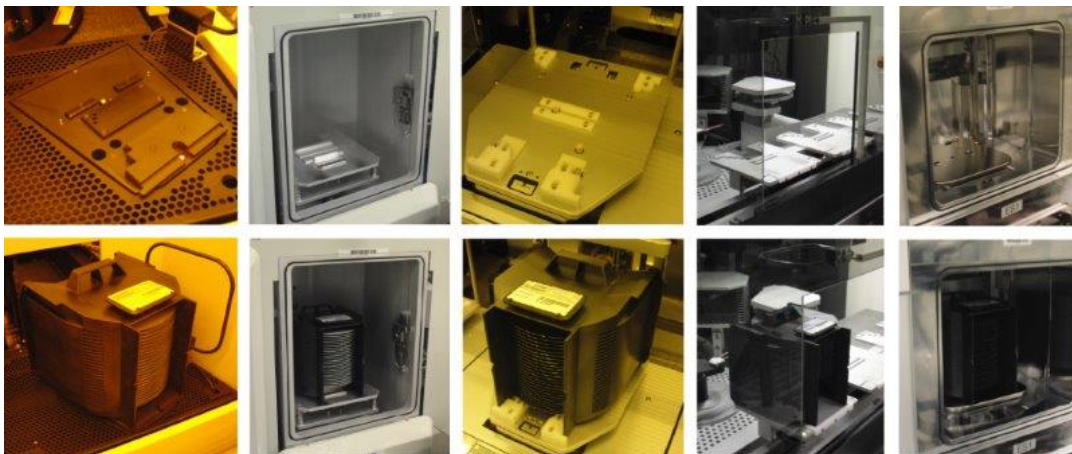
Abbildung 3.4: Beispielhafte Darstellung fünf unterschiedlicher Loadports; das obere Bild zeigt jeweils das leere Loadport und das untere Bild dasselbe Loadport mit einer mit Wafern gefüllten Horde beladen.
