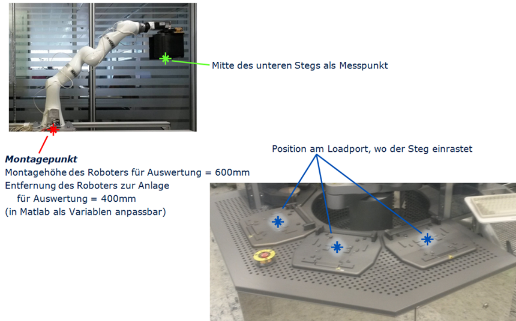
Abbildung 4.5: Definition von Montagepunkt des Roboterarms, Messpunkt am Endeffektor des Roboterarms (am unteren Steg der Horde am Greifer) und Messpunkten an den Loadports.
