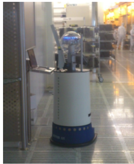
(b) Tatsächlich vorgekommene Kollision von Scitos mit einem an der Wand montierten Laptop wegen unterschiedlicher Höhe von Sensorik und Hindernis.
