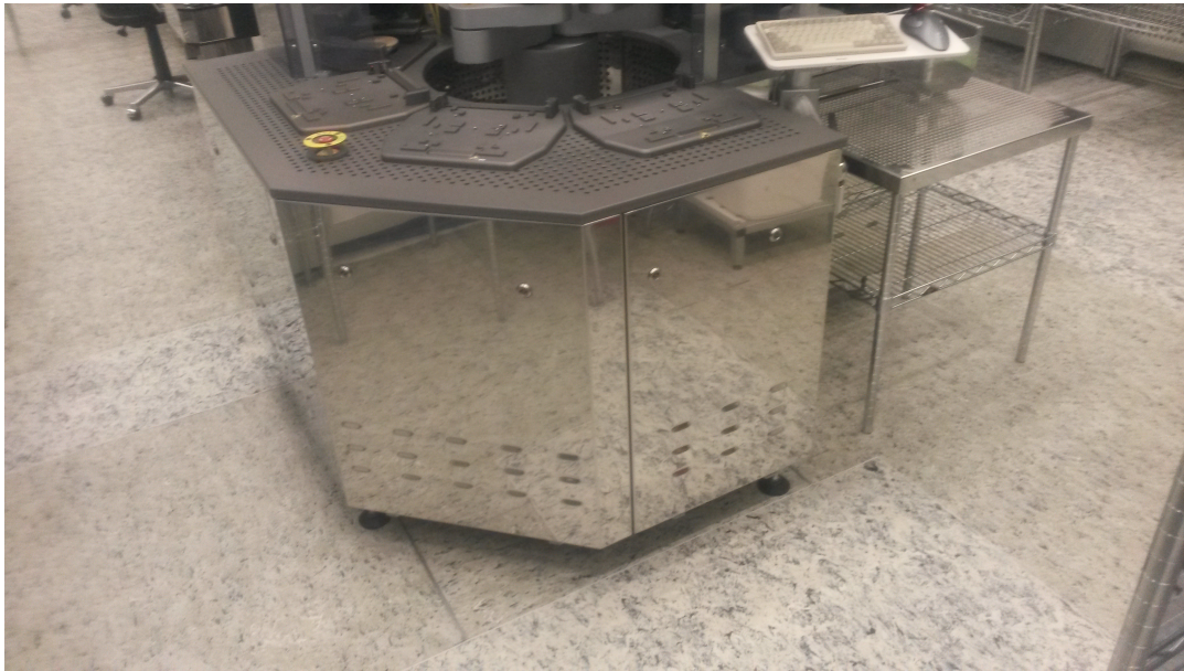
Abbildung 6.9: Für erste Tests durch Anlagenform und -größe, sowie Höhe, Zugänglichkeit und Anordnung der Loadports empfohlener Anlagenstil.
