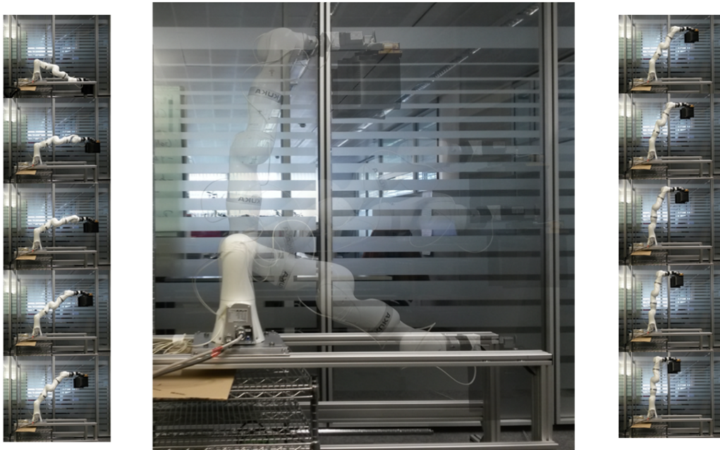
Abbildung 4.4: Test am Roboterarm LBR iiwa zur Erfassung der Reichweite mit Horde am Greifer in der häufigsten Beladestellung.
