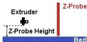
Abbildung 22: Benötigter Offset (Z-Probe Height) zur Korrektur der Nullpunktsetzung [24]
