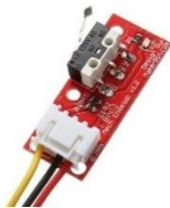
Abbildung 12: Mechanischer Mikroschalter mit PCB [11].
