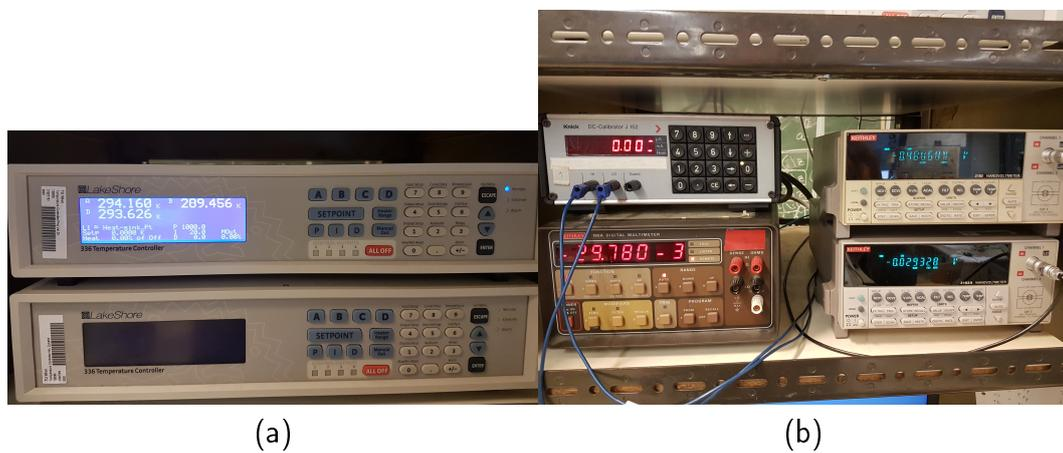
Abbildung 5.5: Messgeräte: (a) Lakeshore 336 (b) Knick DC-Calibrator, Keithley Multi-meter 195A, Keithley Nanovoltmeter 2182 und 2182A
