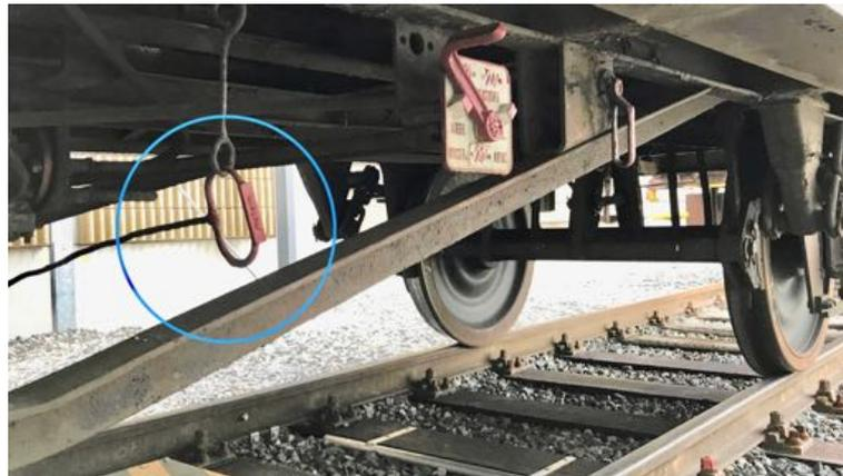
Abbildung 3.2: Beispiel für einen Lösezug (Markierung) [vgl. 38]
