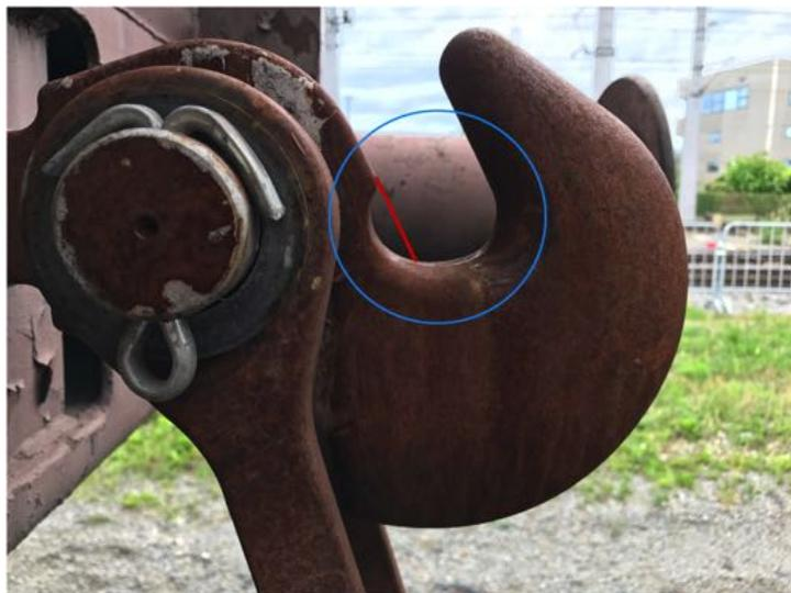
Abbildung 3.12: Bild eines Zughakens (problematische Geometrie siehe Markierung)
