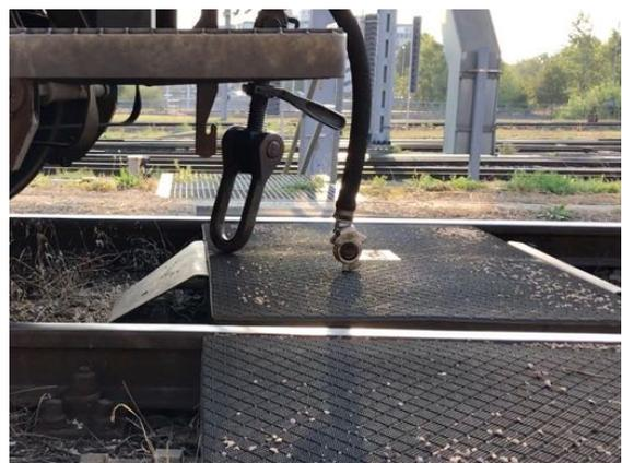
(b) Schraubenkupplung und Bremsschlauch unversorgt, Höhe SOK
