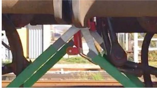
*Abbildung 8.16: Aufgetretene Probleme beim automatischen Entkuppeln, Stangenbruch*
