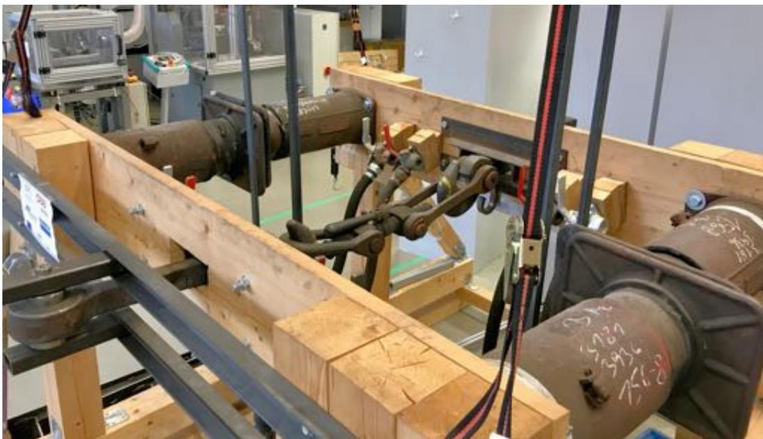
Abbildung 8.1: Versuchsaufbau mit originalen Bauteilen von Güterwagen (Schraubenkupplung, Bremsschläuche, Puffer)
