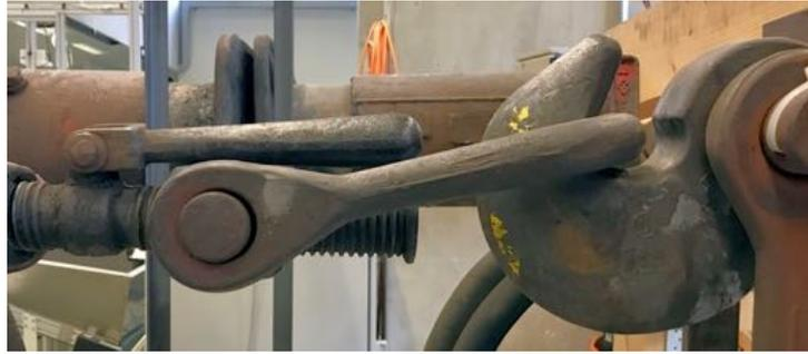
Abbildung 8.5: Oben liegender Kupplungsschwengel, Schraubenkupplung leicht aufgeschraubt
