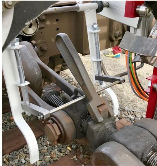
Abbildung 8.7: Positionierung Kupplungsschwengel, Feldtest
