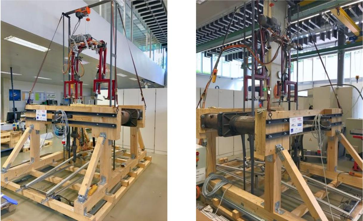
Abbildung 8.2: Versuchsaufbau mit Demonstratoren für das Langmachen und Entkuppeln [vgl. 43, S.28]
