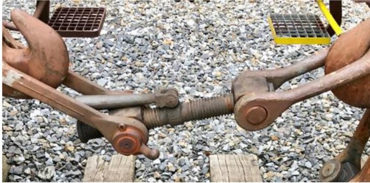
Abbildung 8.9: Beispiel für eine einseitig aufgeschraubte Schraubenkupplung
