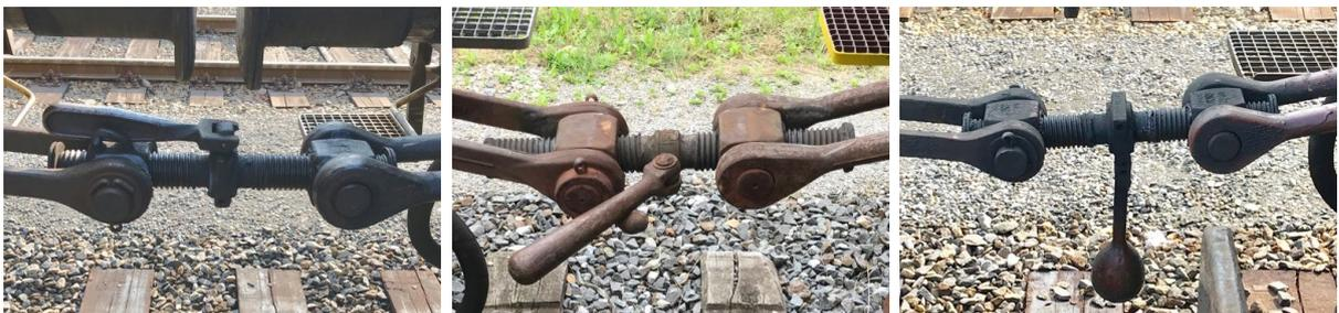
(a) Oben liegend (flach)      (b) Im Sicherungshaken (konisch)      (c) Freihängend nach unten (kugelförmig)
