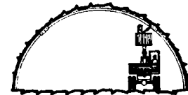
Bogen setzen, Spritzbeton aufbringen
