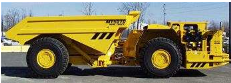
Abb. 3.2-13 Muldenkipper MHK Atlas Copco MT 5010 - gedrungene Tunnelausführung [10]
