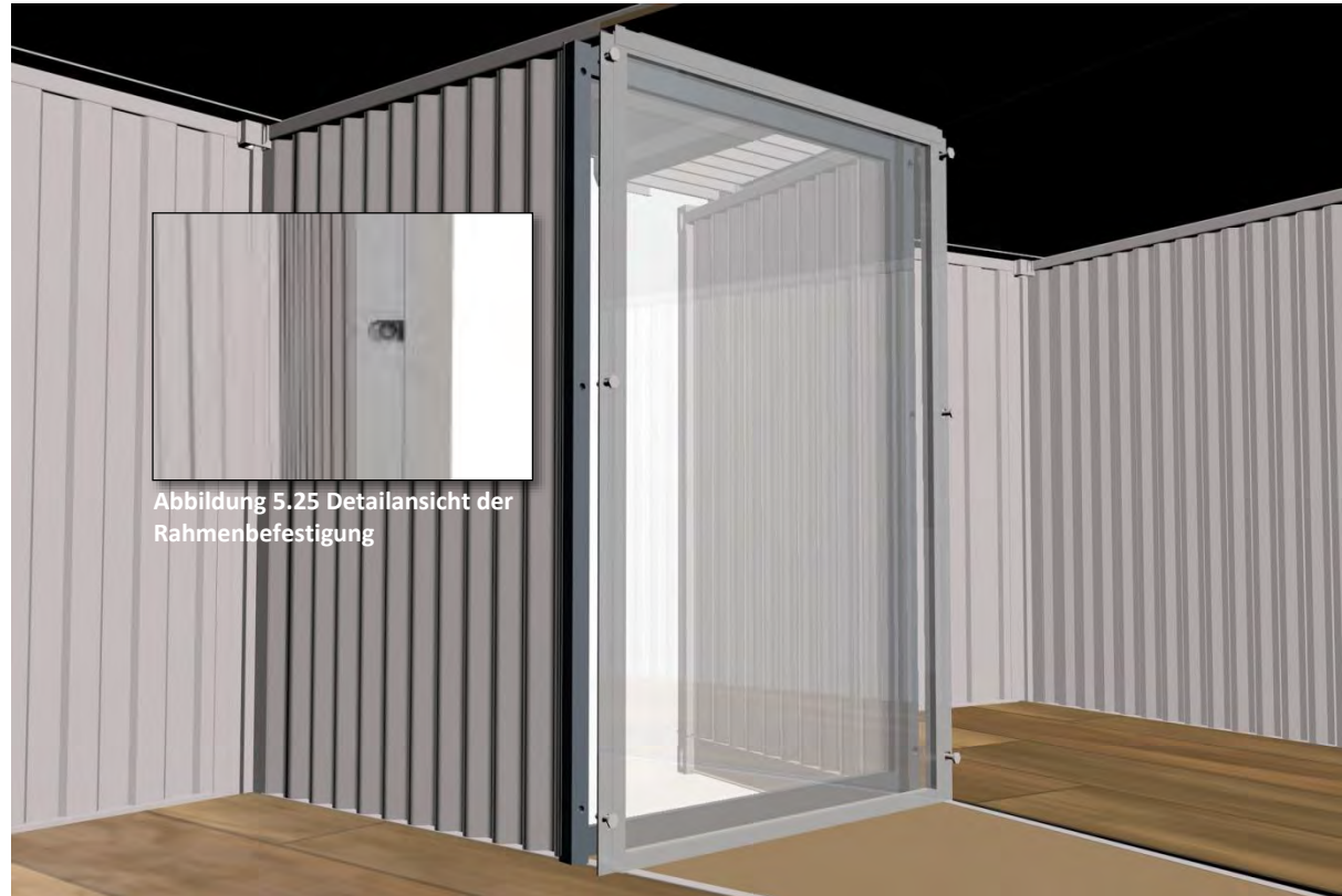
Abbildung 5.24 Anbringung der Fensterkonstruktion
