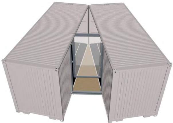
Abbildungen 5.8 Einsetzen des Fensterelements
