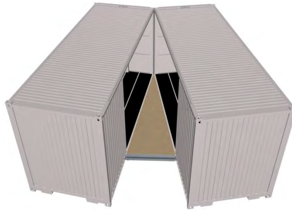
Abbildung 5.6 Fußboden (Sperrholzplatte) wird befestigt
