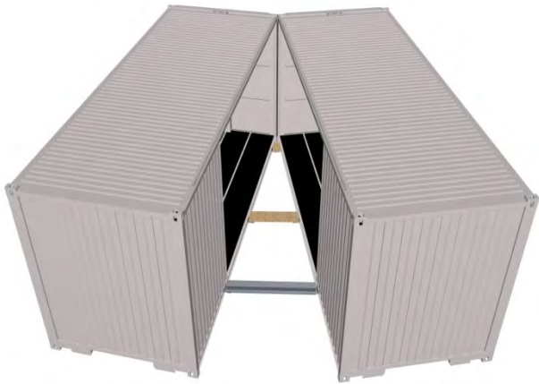
Abbildung 5.5 Träger werden an den Profilen befestigt
