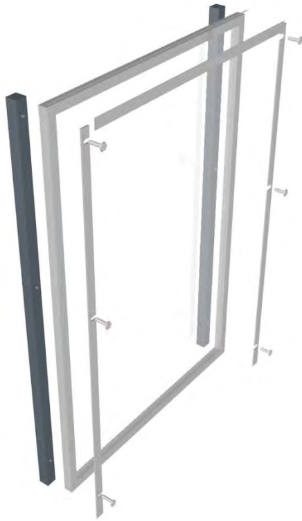
Abbildung 5.23 Aufbau des Fensterelementes
