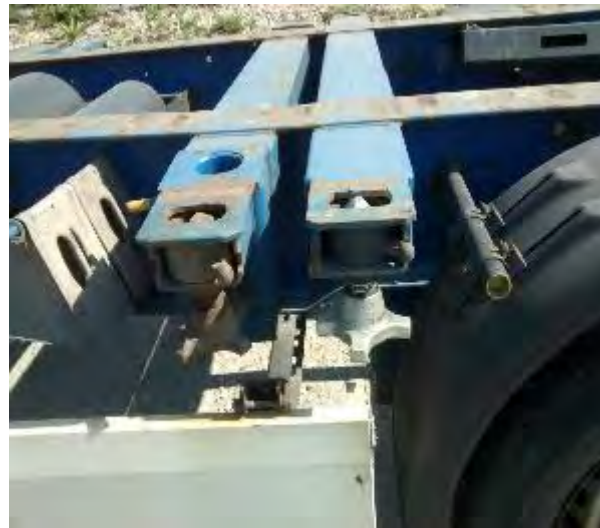
Abbildung 3.24 Befestigungspunkt eines LKW Anhänger
