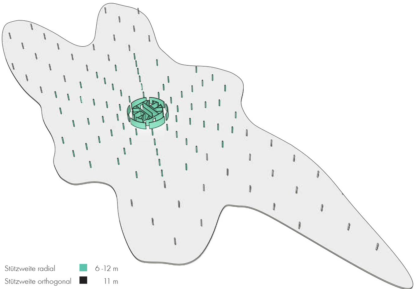
Im Gebäudekomplex gibt es zwei verschiedene Stützenraster. Um den rund ausgebildeten Kern sorgt eine radial aufgeteilte Stützenanordnung für die Lastabtragung des Wohnturms. Die Lasten werden vom Penthouse bis hinunter ins Fundament geleitet. Dabei laufen die Stützen auch durch die unterirdisch
