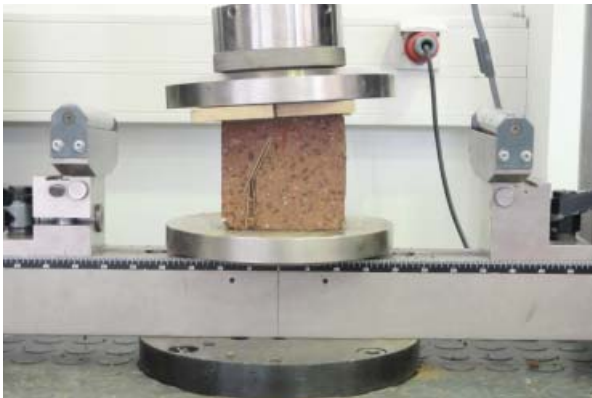
PROBEKÖRPER 2 9,9 x 10,0 x 10,0 cm, 1743 g \sigma = 0,92 \text{ N/mm}^2
