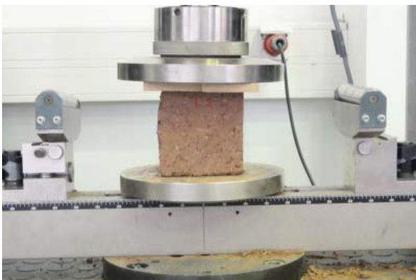
PROBEKÖRPER 3 10 x 10 x 9,9 cm, 1743 g \sigma = 0,85 \text{ N/mm}^2
