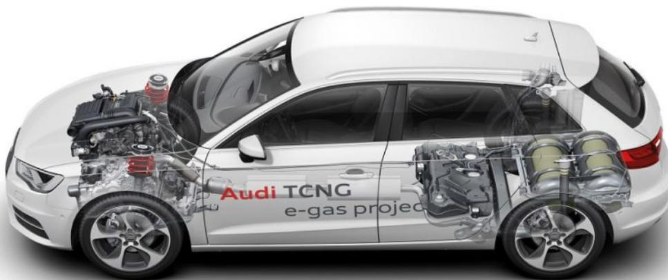
**Abb 27: Aufbau der Fahrzeugs Audi A3 sportback g-tron**
