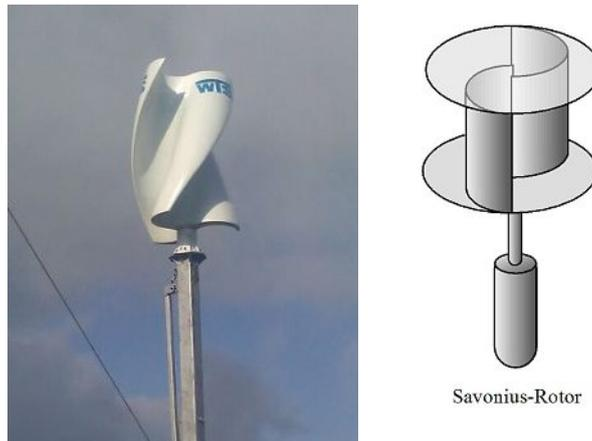
Abb 5: Savonius Rotor (links geschwungene Form); rechts (konventionelle Form)
