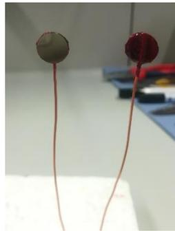
Abbildung 14 Kontaktierung der Arbeits elektrode
