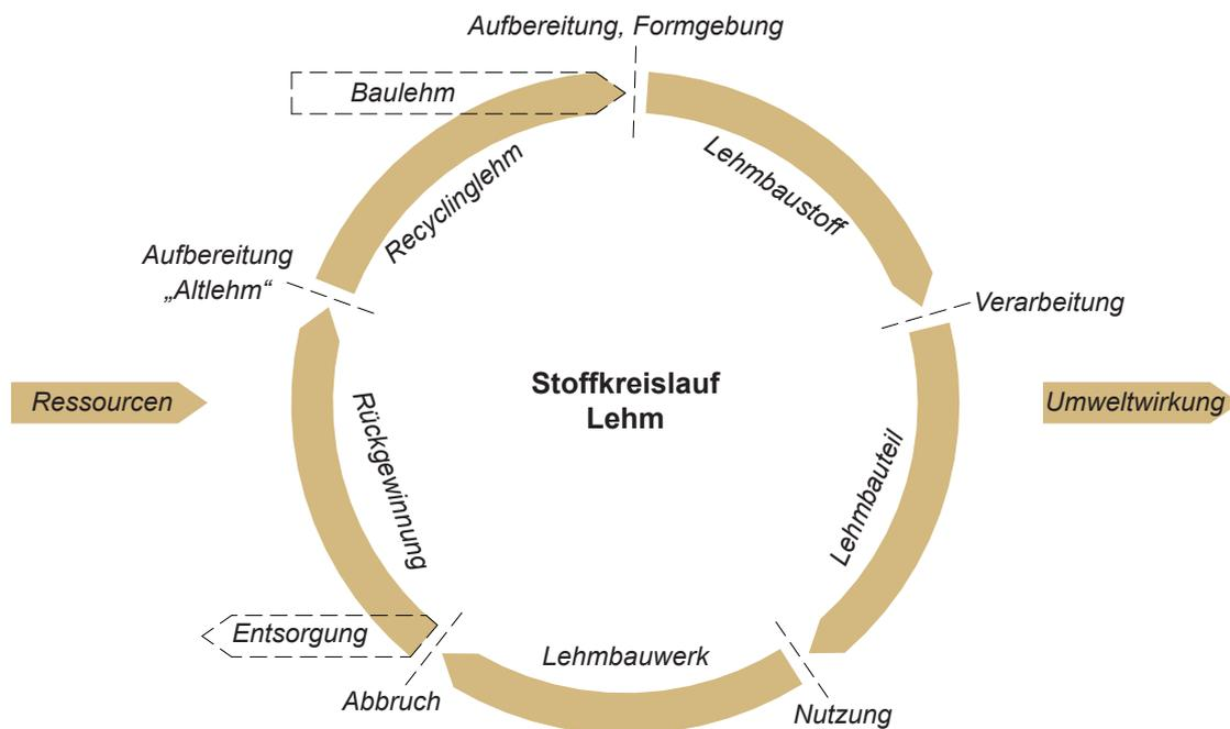
Abbildung 28: Stoffkreislauf des Baustoffes Lehm<sup>174</sup>
