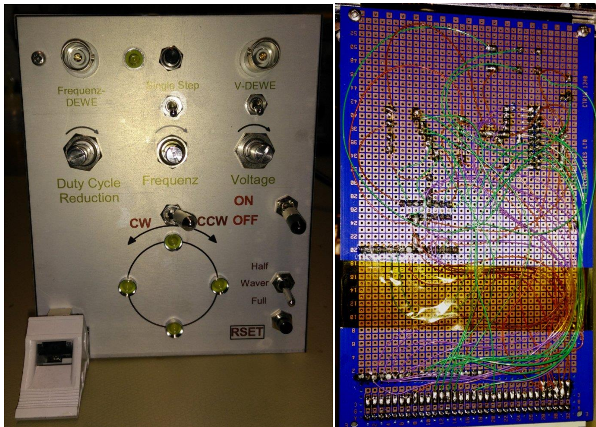
Abbildung 33: Frontpanel der Starting-Current und Lochplatte von unten
